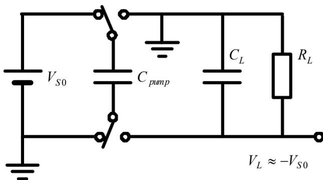
电容电荷重分配时，电流流过开关（晶体管、二极管），非线性电阻耗能。这里为了简化分析，把晶体管抽象为理想开关，电容电荷重分配在开关拨动瞬间完成，以冲激电流（电磁辐射）形态表现。事实上，这部分能量基本上是被晶体管消耗掉的，但计算时，只能以理想开关电磁辐射能量估计。
