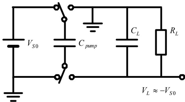
$$V_3 \approx V_2 \left( 1 - \frac{0.5T}{R_L C_L} \right) \quad \text{开关左拨半周期}$$
