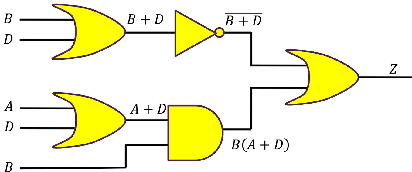
$$Z = A \cdot B + B \cdot D + \overline{B} \cdot \overline{D} = B \cdot (A + D) + \overline{B + D}$$
