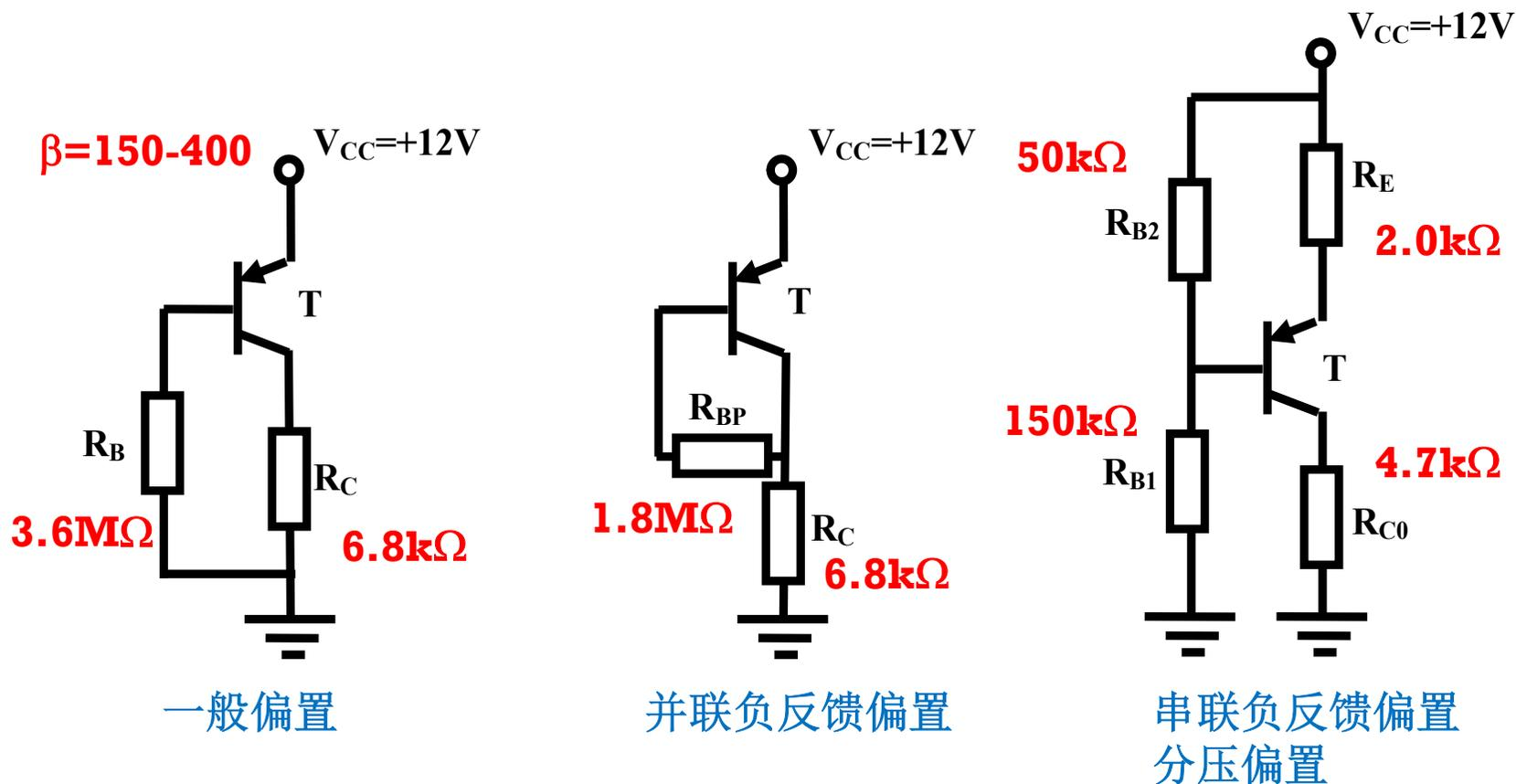
分析上述三个电路的BJT的直流工作点： $I_C=?$   $V_{EC}=?$ 说明负反馈可以稳定直流工作点
