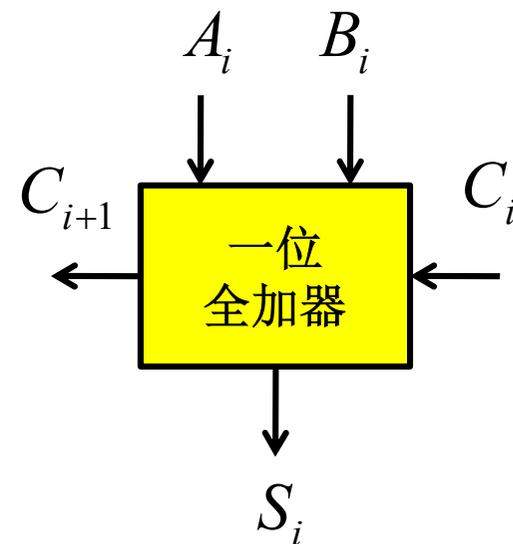
$$S_i = \overline{A_i} \cdot \overline{B_i} \cdot C_i + \overline{A_i} \cdot B_i \cdot \overline{C_i} + A_i \cdot \overline{B_i} \cdot \overline{C_i} + A_i \cdot B_i \cdot C_i$$
