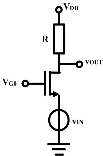
本题意图告知：只有工作在恒流区，输入输出转移特性曲线具有最大的斜率，也就是说具有最大的增益，因而做放大器使用时，应将晶体管偏置在恒流导通区
