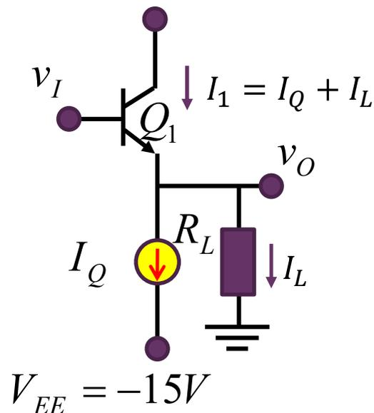
前级电路等效戴维南电压源内阻的限流作用， $v_I$ 电压被限制在 $V_{CC} + 0.7V$ 以内，此处电压最高 $V_{CC}$ ，晶体管位于饱和区；对于MOSFET，即使是理想恒压源 $v_I$ 驱动，此处电压最高也是 $V_{DD}$ ，此时晶体管位于欧姆导通区
