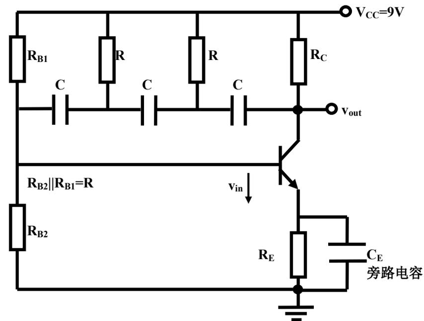
该同学给出了如图**8b**所示的电路设计，他没有对这个电路进行进一步的交流小信号分析，而是直接依照对图**8a**电路的分析给出如下设计方案：由于振荡频率设计值为**6kHz**，取
