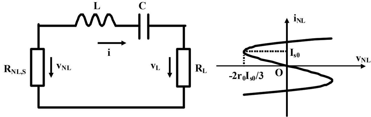
$L=100\mu\text{H}$ ,  $C=20\text{pF}$ ,  $R=100\Omega$ ,  $I_0=1\text{mA}$ ,  $v_C(0)=10\text{mV}$ ,  $i_L(0)=0$
