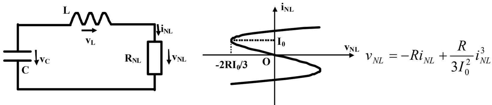
$L=100\mu\text{H}$ ,  $C=20\text{pF}$ ,  $R=100\Omega$ ,  $I_0=1\text{mA}$ ,  $v_C(0)=10\text{mV}$ ,  $i_L(0)=0$
