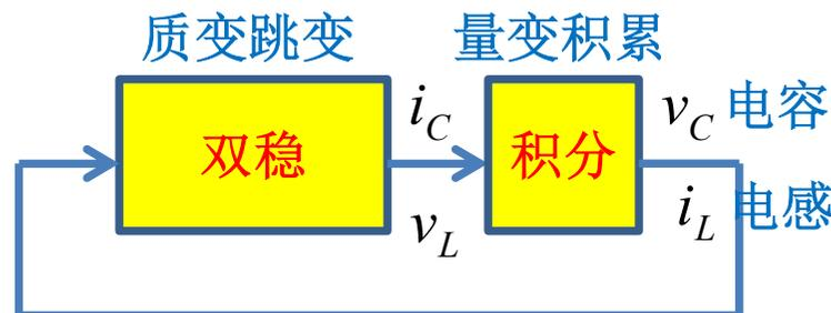
张弛振荡器平衡原理模型
