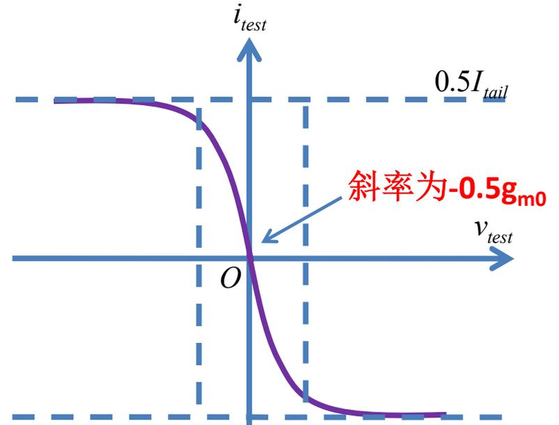
在结点正弦电压激励下，非线性N型负阻产生了基波电流分量和高次谐波电流分量，其中，只有基波电流分量可以通过并联LC谐振腔到达负载电阻上，高次谐波分量则无法通过LC谐振腔到达负载电阻，因而N型负阻和LC并联谐振腔共同被视为只产生基波分量的准线性负导，该准线性负导随振荡幅度增加反比下降
