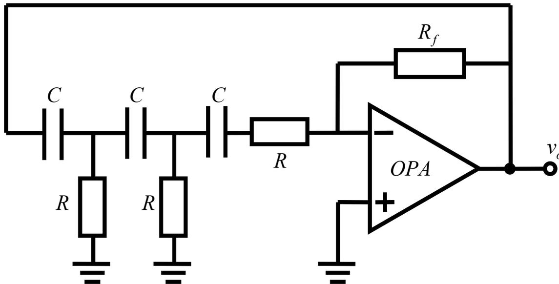
提示：放大网络和反馈网络划分时，应确保放大网络具有理想受控源特性，于是则可将等效受控源之外的所有其他元件全部划分到反馈网络中，如是分析可有效去除负载效应，获得正确的分析结果。
