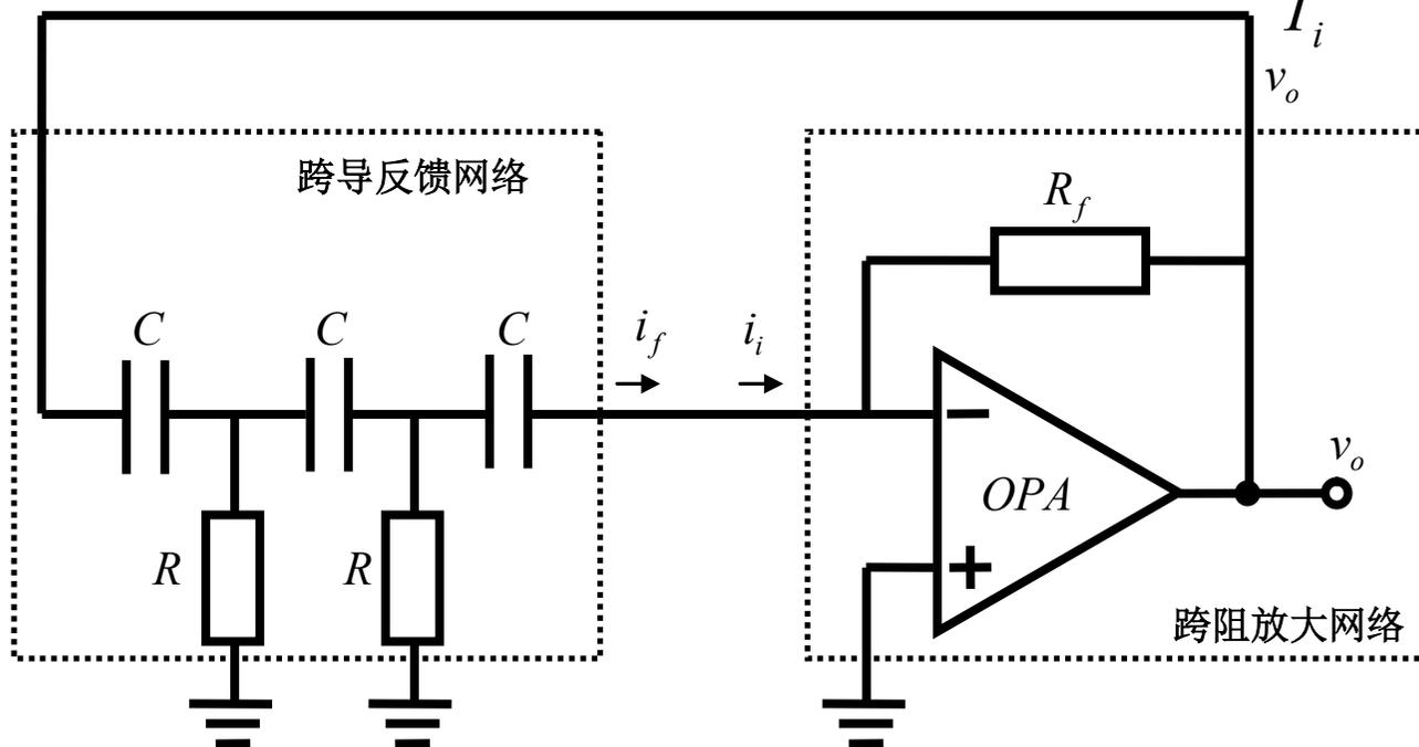
**跨导反馈网络：**将放大器输出电压转化为反馈电流
