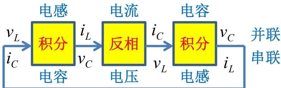
正弦振荡器平衡原理模型
