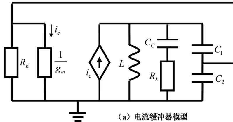
(a) 电流缓冲器模型
