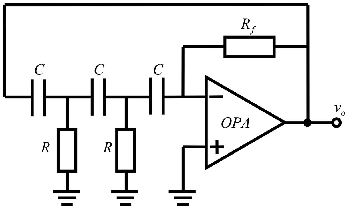
一个电容最多移相 $90^\circ$ ，两个电容最多移相 $180^\circ$ ，三个电容则肯定可移相超过 $180^\circ$ ，在特定频点上，阻容反馈网络移相 $180^\circ$ ，反相放大器移相 $180^\circ$ ，构成闭合共移相 $360^\circ$ ，则可形成正反馈通路
