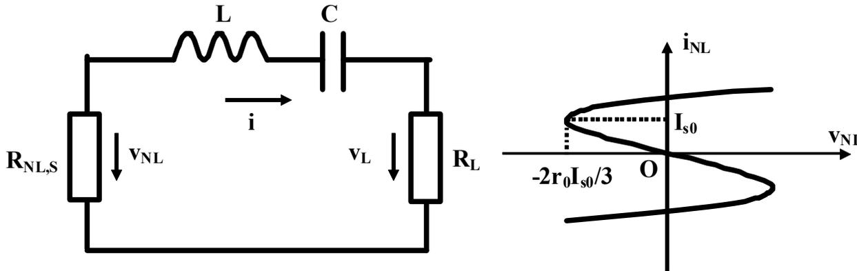
$$v_{NL} = -r_0 i_{NL} + \frac{r_0}{3I_{s0}^2} i_{NL}^3$$
