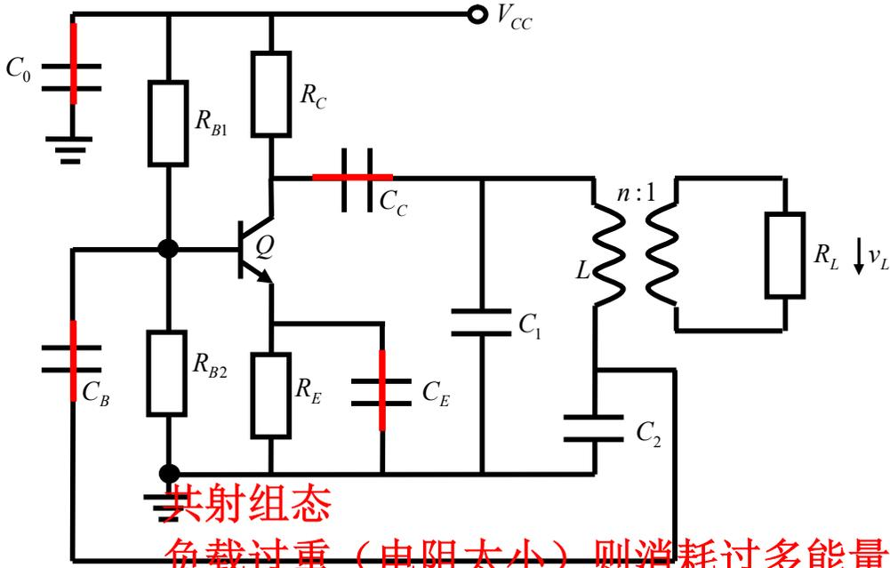
负载过重 (电阻太小) 则消耗过多能量, 晶体管等效负阻无法提供足够补充能量, 不满足起振条件
