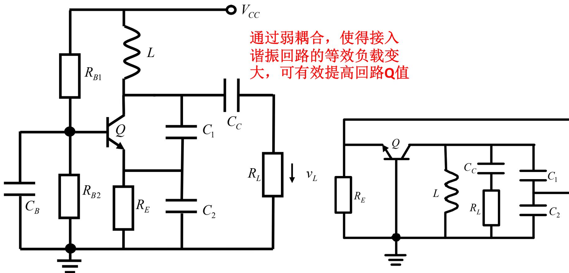
只要是三点式结构即是正反馈结构，晶体管的地在哪里并无关系：共基组态的电容三点式振荡器
