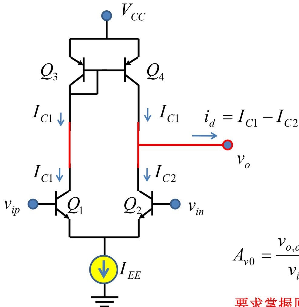
整体上看，这是一个差分输入单端输出的跨导器，跨导器输出阻抗为两个晶体管输出阻抗的并联
