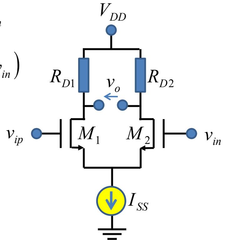
设计中，结构是完全对称的，输出差模电压中，只有对差模输入电压 $v_{id}$ 的放大，而没有对共模电压 $v_{ic}$ 的放大，故称差分对
