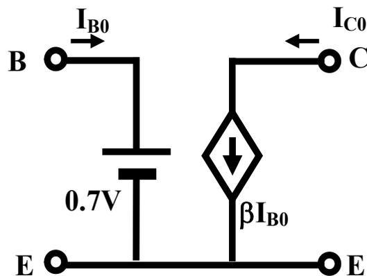
(b) 直流分析电路模型
