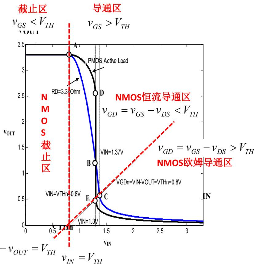
晶体管位于恒流区，反相特性有剧烈的变化：斜率最大区位于晶体管恒流区，做交流小信号放大器使用时，晶体管应位于恒流区
