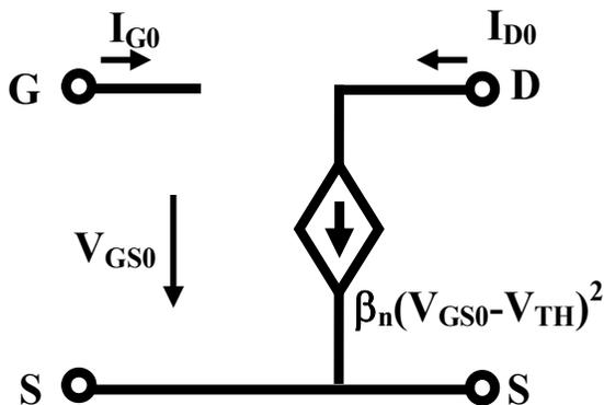
(b) 直流分析电路模型
