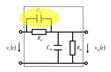
• 3、假设示波器输入电阻R<sub>in</sub>为1MΩ,输入电容C<sub>in</sub>为10pF,衰减电阻R<sub>a</sub>为9MΩ,补偿电容C<sub>a</sub>最佳值C<sub>aopt</sub>为多少?画出C<sub>a</sub>=0.5C<sub>aopt</sub>,C<sub>aopt</sub>,C<sub>aopt</sub>,E种情况下的阶跃响应曲线
