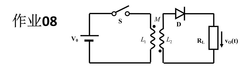
仅一端有电流的变压器退化为一阶电感
