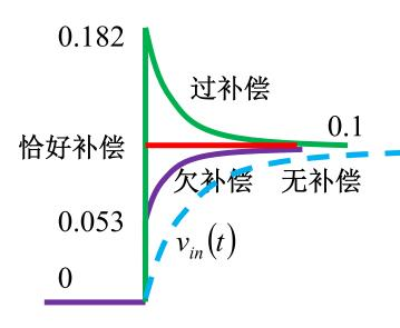
早期示波器的探头补偿电容 需要手工调准,调准方法就是观测方波激励下的响应
