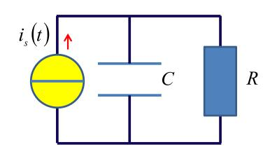
设定某一电路 求对应该电路的 冲激响应和阶跃响应 阶跃电流  $i_s(t) = I_{so}U(t)$  作用
