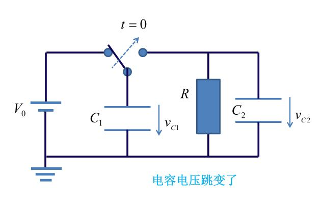
• 在t=0时刻, 将开关拨向 右侧电路, 求电容 $C_1$ 、 C,两端电压 变化规律, 写出表达式, 画出时域波 形
