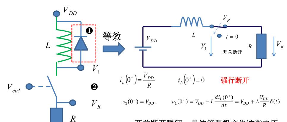
开关断开瞬间,晶体管漏极产生冲激电压
