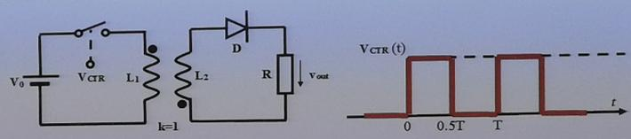
由于是全耦合变压器，因此如图所示的等效电路中不存在漏磁电感，只有励磁电感 $L_1$ ，图中，理想变压器的变压比 $n = \sqrt{\frac{L_1}{L_2}}$
