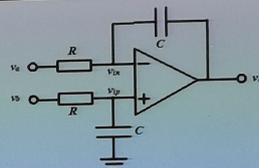
$$\dot{V}_o = \frac{1}{R} \int (\dot{V}_b - \dot{V}_a) dt = \frac{1}{j\omega RC} (\dot{V}_b - \dot{V}_a)$$
