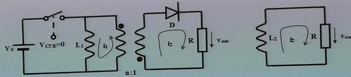
在第二个半周期时( $0.5T \leq t \leq T$ ),  $V_{CTR}$ 为低电平, 开关断开,  $L_1$ 电流保持连续, 导致次级回路电流流过二极管(二极管正偏导通),  $t = 0.5T$ 瞬间, 回路2电流为
