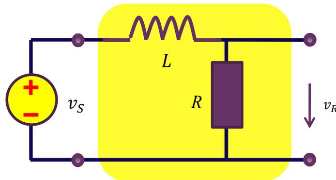
$$H(j\omega) = \frac{\dot{V}_R(j\omega)}{\dot{V}_S(j\omega)} = \frac{R}{R + j\omega L} = \frac{1}{1 + j\omega GL}$$
