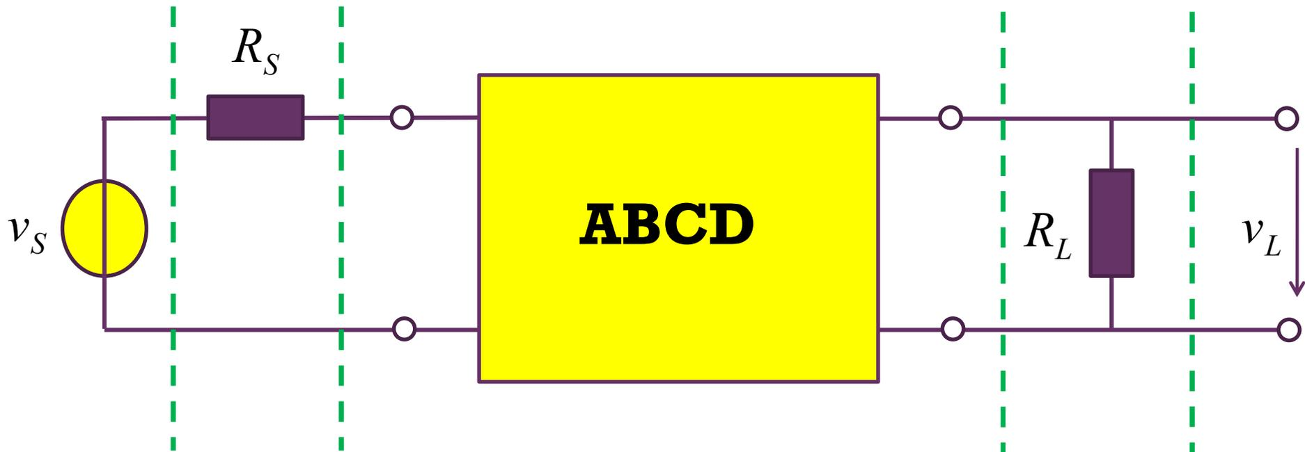
$$\begin{bmatrix} A_c & B_c \\ C_c & D_c \end{bmatrix} = \begin{bmatrix} A_S & B_S \\ C_S & D_S \end{bmatrix} \begin{bmatrix} A & B \\ C & D \end{bmatrix} \begin{bmatrix} A_L & B_L \\ C_L & D_L \end{bmatrix} = \begin{bmatrix} 1 & R_S \\ 0 & 1 \end{bmatrix} \begin{bmatrix} A & B \\ C & D \end{bmatrix} \begin{bmatrix} 1 & 0 \\ \frac{1}{R_L} & 1 \end{bmatrix} = \begin{bmatrix} A + CR_S + \frac{B + DR_S}{R_L} & \dots \\ \dots & \dots \end{bmatrix}$$
