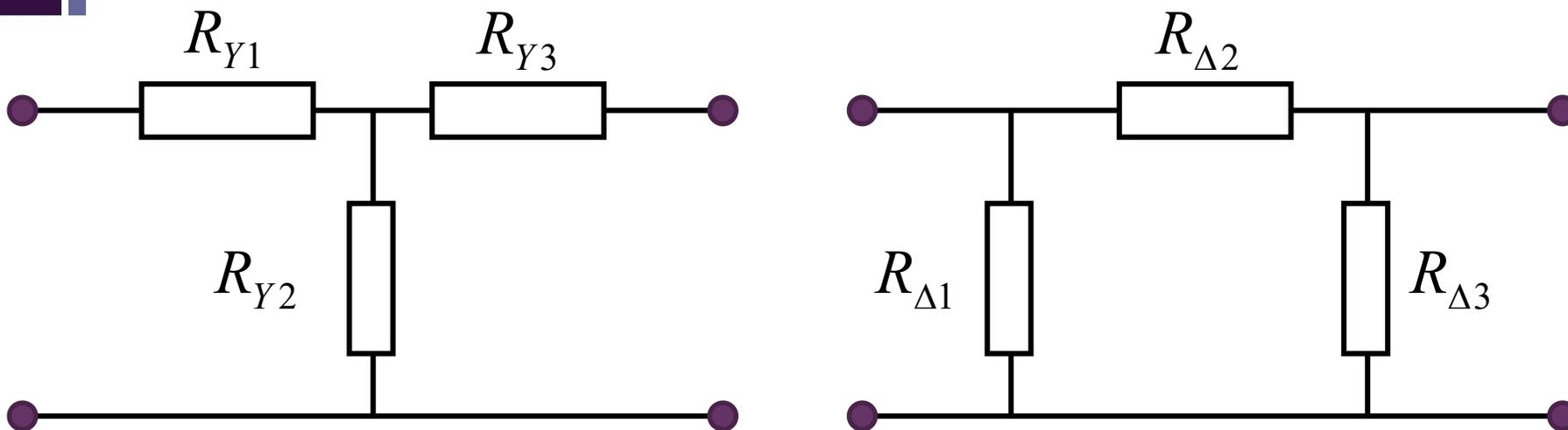
$$ABCD_T = \begin{bmatrix} 1 & R_{Y1} \\ 0 & 1 \end{bmatrix} \begin{bmatrix} 1 & 0 \\ \frac{1}{R_{Y2}} & 1 \end{bmatrix} \begin{bmatrix} 1 & R_{Y3} \\ 0 & 1 \end{bmatrix} = \begin{bmatrix} 1 + \frac{R_{Y1}}{R_{Y2}} & R_{Y1} + R_{Y3} + \frac{R_{Y1}R_{Y3}}{R_{Y2}} \\ \frac{1}{R_{Y2}} & 1 + \frac{R_{Y3}}{R_{Y2}} \end{bmatrix}$$
