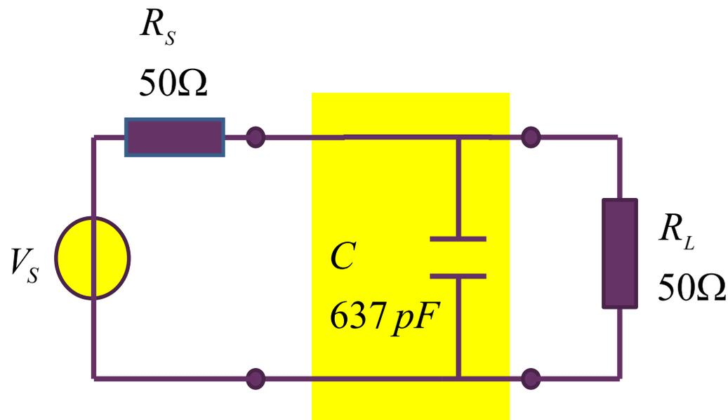
1、有信源内阻和负载电阻的无源滤波器设计，无源滤波器二端口网络应该 是无损网络，如果信源内阻和负载电阻不等，可能还需阻抗变换网络
