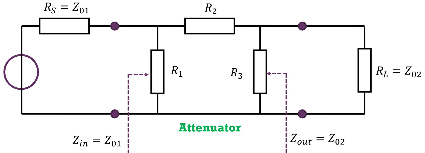
设计要求：端口1匹配于 $Z_{01}$ 阻抗，端口2匹配于 $Z_{02}$ 阻抗，功率衰减 $L$ dB
