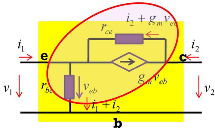
$$v_1 = (i_1 + i_2)r_{be} = r_{be}i_1 + r_{be}i_2$$
