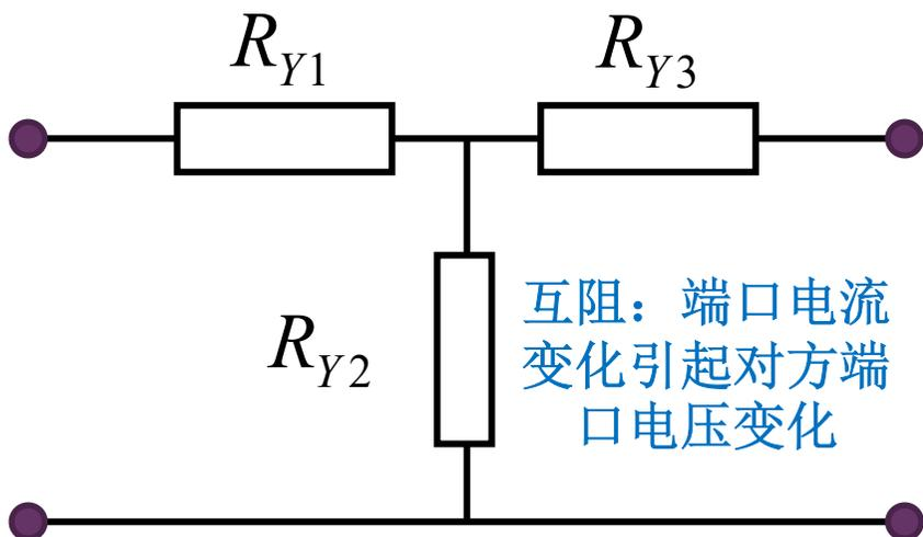
$$\mathbf{z} = \begin{bmatrix} R_{Y1} + R_{Y2} & R_{Y2} \\ R_{Y2} & R_{Y3} + R_{Y2} \end{bmatrix}$$
