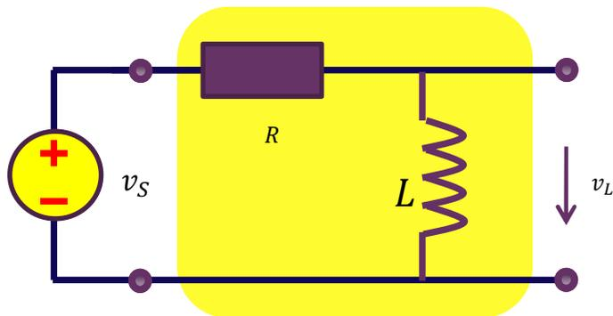
$$H(j\omega) = \frac{\dot{V}_L(j\omega)}{\dot{V}_S(j\omega)} = \frac{j\omega L}{R + j\omega L} = \frac{j\omega GL}{1 + j\omega GL}$$
