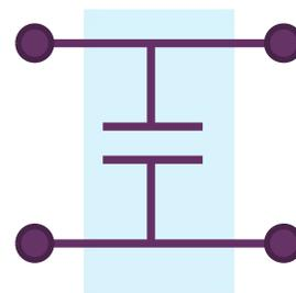
并臂电容：低频开路，信号可以通过，高频短路，信号不能通过，故而低通
