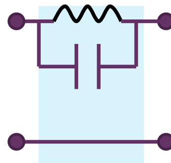
并联**LC**在串臂：低频电感短路信号可过，高频电容短路信号可过，谐振频点并联**LC**开路，信号不能通过，故而带阻
