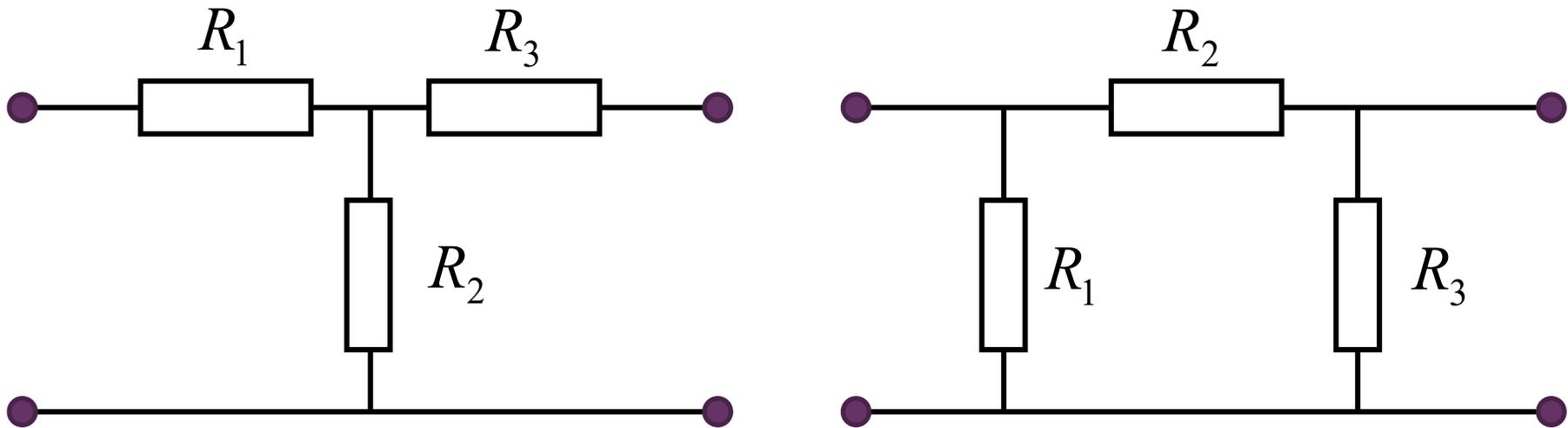
$\pi$ 型电阻衰减器设计公式已知，根据对偶性给出T型电阻衰减器的设计公式
