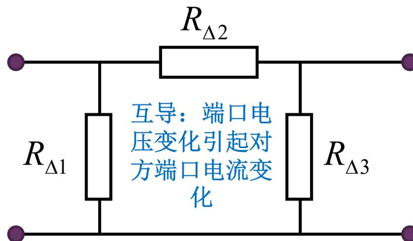
$$\mathbf{y} = \begin{bmatrix} G_{\Delta1} + G_{\Delta2} & -G_{\Delta2} \\ -G_{\Delta2} & G_{\Delta3} + G_{\Delta2} \end{bmatrix}$$
