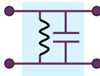
并联**LC**在并臂：低频电感短路通不过，高频电容短路通不过，谐振频点并联**LC**开路，信号可以通过，故而带通
