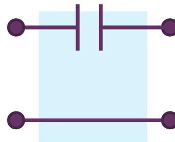
串臂电容：低频开路，信号不能通过，高频短路，信号可以通过，故而高通
