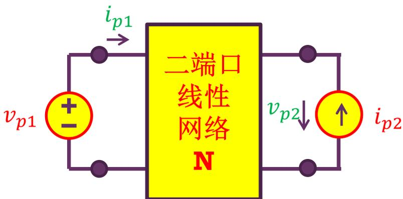
端口**1**加测试电压同时端口**2**加测试电流
