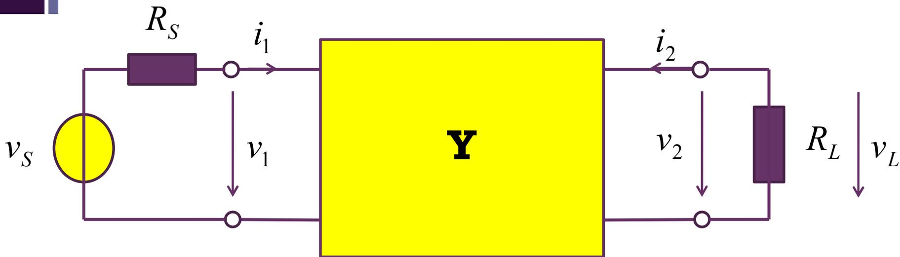
列写电路方程并求解：简单对接关系，一套端口电压、电流，**KVL**、**KCL**自动满足，只需列写元件约束方程即可
