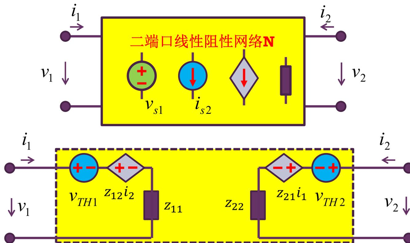
$$\begin{bmatrix} v_1(t) \\ v_2(t) \end{bmatrix} = \begin{bmatrix} z_{11} & z_{12} \\ z_{21} & z_{22} \end{bmatrix} \begin{bmatrix} i_1(t) \\ i_2(t) \end{bmatrix} + \begin{bmatrix} v_{TH1}(t) \\ v_{TH2}(t) \end{bmatrix}$$
