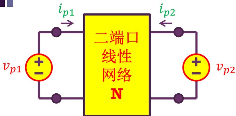
两个端口同时加独立变化的测试电压
