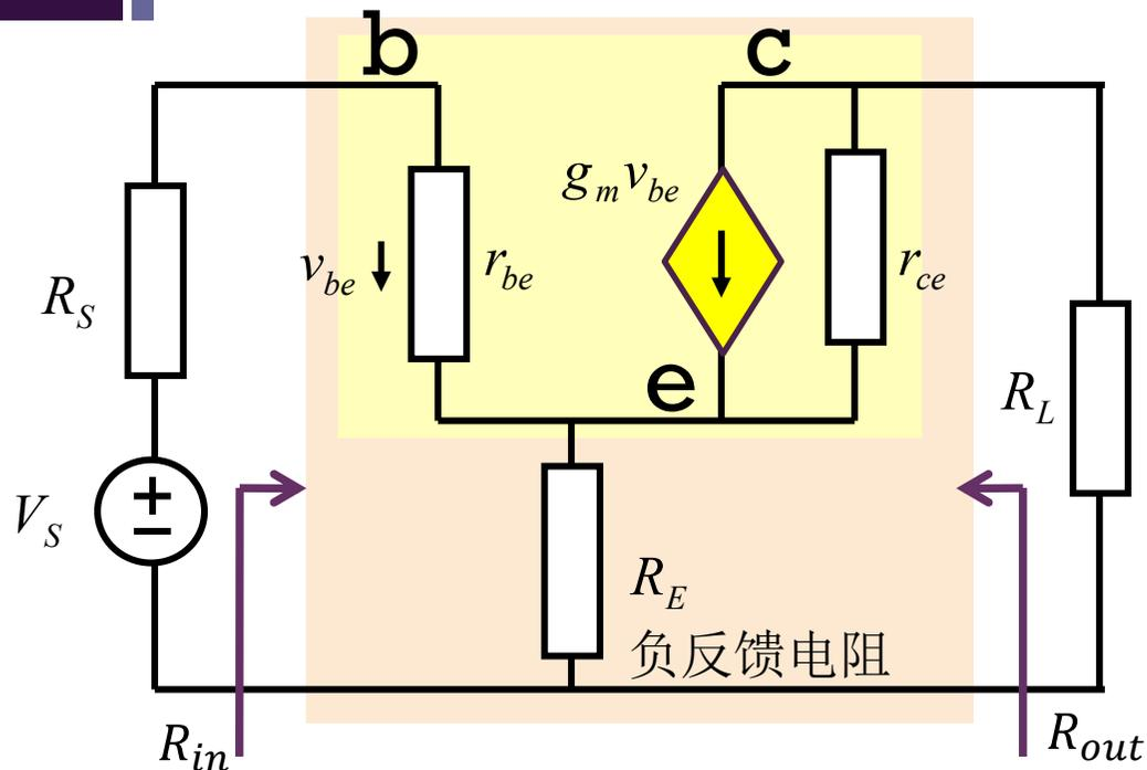
$$\mathbf{z} = \begin{bmatrix} r_{be} + R_E & R_E \\ R_E - g_m r_{be} r_{ce} & r_{ce} + R_E \end{bmatrix}$$
