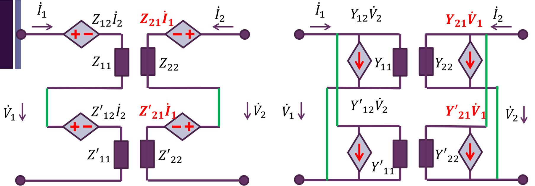
串串连接Z相加     串联电压相加, 阻抗相加     并并连接Y相加
