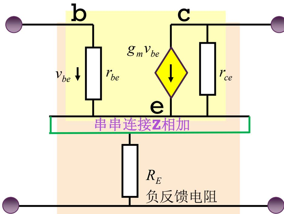
$$v_1 = (i_1 + i_2)R_E \quad v_2 = (i_1 + i_2)R_E$$
