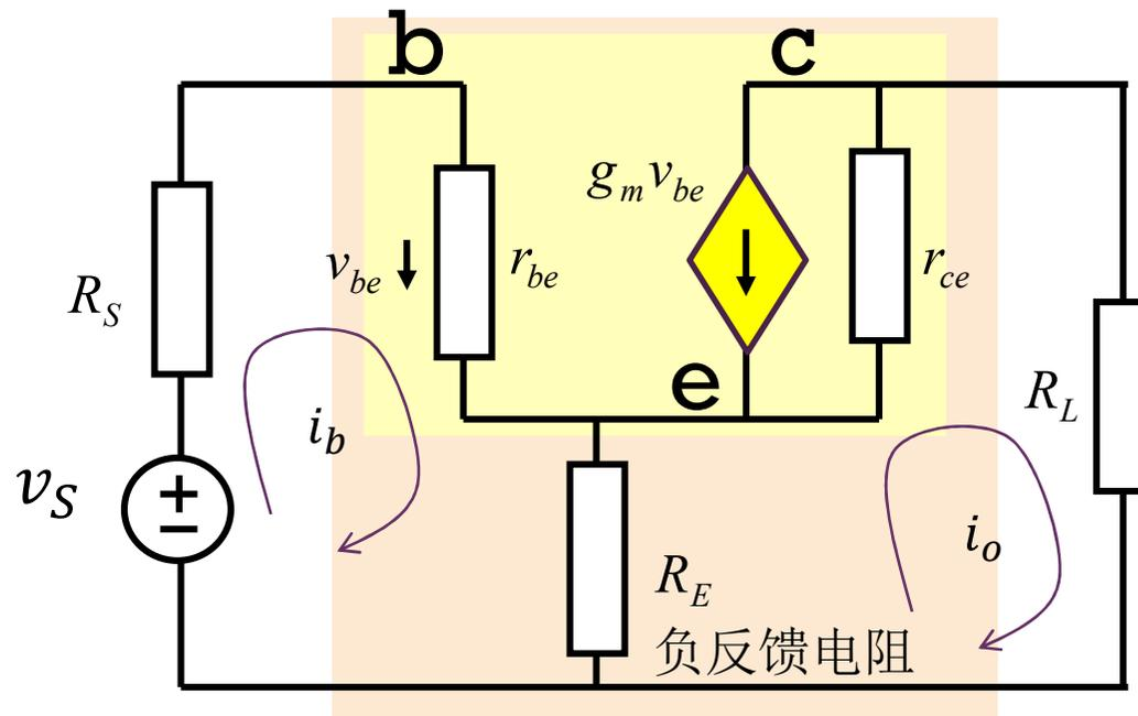
$$\begin{bmatrix} R_S + r_{be} + R_E & -R_E \\ -R_E & R_E + r_{ce} + R_L \end{bmatrix} \begin{bmatrix} i_b \\ i_o \end{bmatrix} = \begin{bmatrix} v_S \\ -g_m v_{be} r_{ce} \end{bmatrix} = \begin{bmatrix} v_S \\ -g_m r_{be} r_{ce} i_b \end{bmatrix}$$
