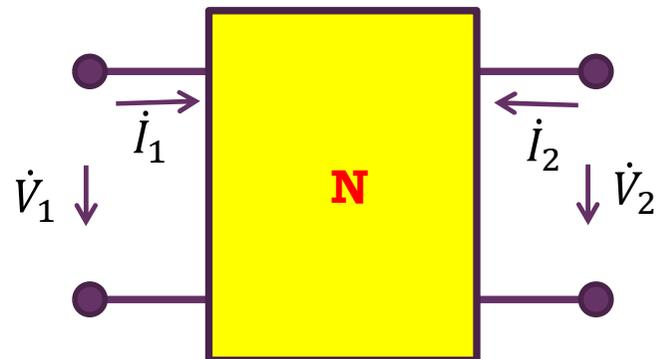
$$\begin{bmatrix} \dot{V}_1 \\ \dot{I}_1 \end{bmatrix} = \begin{bmatrix} A & B \\ C & D \end{bmatrix} \begin{bmatrix} \dot{V}_2 \\ -\dot{I}_2 \end{bmatrix}$$
