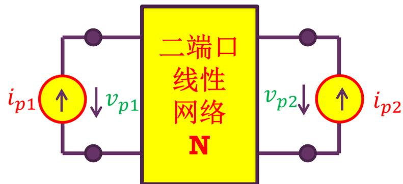
两个端口同时加独立变化的测试电流
