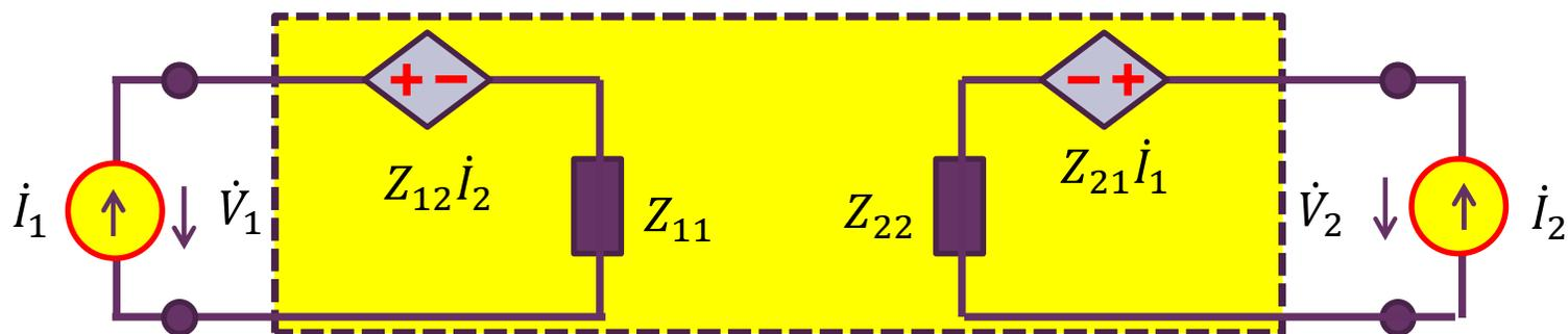
两个端口同时加流测量：阻抗参量
