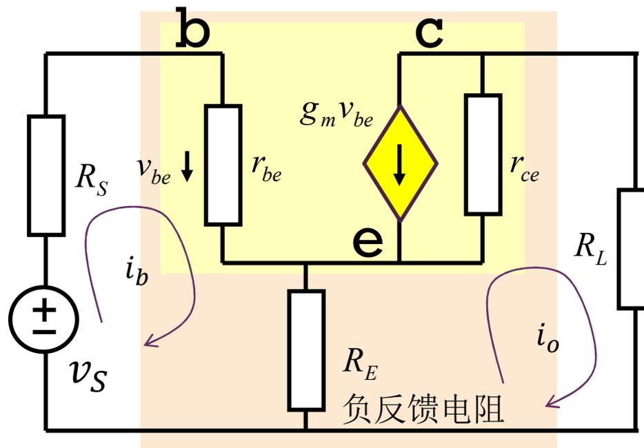
$$\begin{bmatrix} R_S + r_{be} + R_E & -R_E \\ g_m r_{be} r_{ce} - R_E & R_E + r_{ce} + R_L \end{bmatrix} \begin{bmatrix} i_b \\ i_o \end{bmatrix} = \begin{bmatrix} v_S \\ 0 \end{bmatrix}$$
