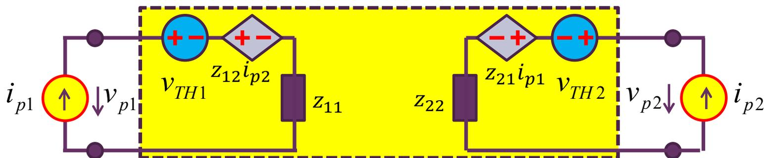
两个端口同时加流测量：阻抗参量
