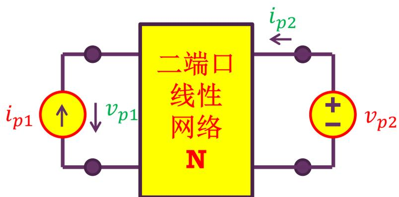
端口**1**加测试电流同时端口**2**加测试电压
