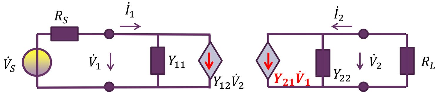
**Y**参量为导纳参量，将戴维南电压源转换为诺顿电流源处理是适当的
