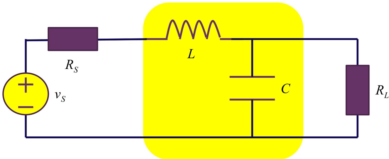
$$\mathbf{z} = \begin{bmatrix} sL + \frac{1}{sC} & \frac{1}{sC} \\ \frac{1}{sC} & \frac{1}{sC} \end{bmatrix} = \begin{bmatrix} j\left(\omega L - \frac{1}{\omega C}\right) & -j\frac{1}{\omega C} \\ -j\frac{1}{\omega C} & -j\frac{1}{\omega C} \end{bmatrix}$$
