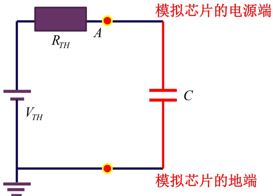
电容**C**具有电压保持功能，具有求平均功能，只要电容足够大， $V_{TH}$ 的变化就会被电容抹平：电源滤波，芯片解耦
