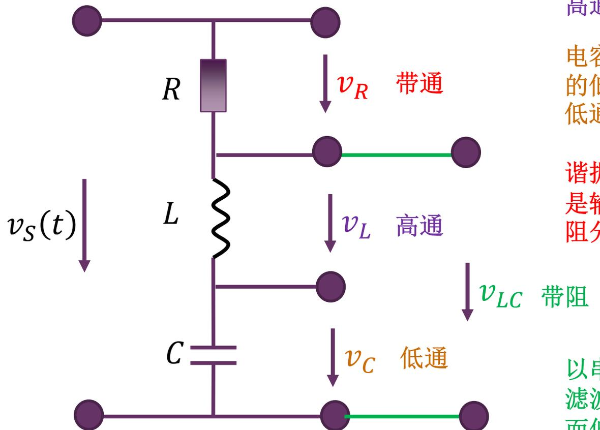
电感高频开路，分担的是输入电压中的高频分量，以电感分压为输出则具高通滤波特性
