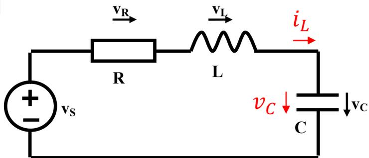
状态方程：就是以电路中的 $n$ 个独立状态变量为未知量列写的 $n$ 个一阶微分方程组，方程左侧为状态变量的一阶微分形式，方程右侧为状态变量和激励变量的代数方程形式
