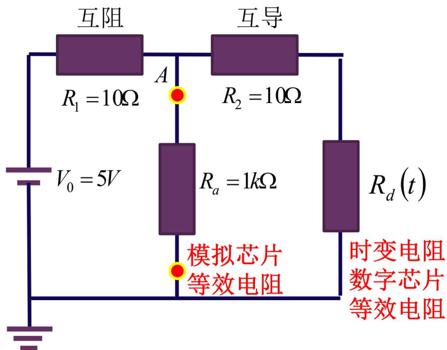
互阻 $R_1$ 和互导 $G_2$ 导致数字芯片和模拟芯片相互耦合，数字芯片的电流变化导致模拟芯片电源电压波动：不开避免的串扰
