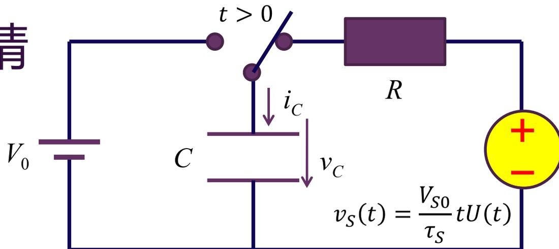
**稳态响应可以猜：** 稳态响应和激励具有相同的形态，同时电容充放电有滞后效应，猜测为
