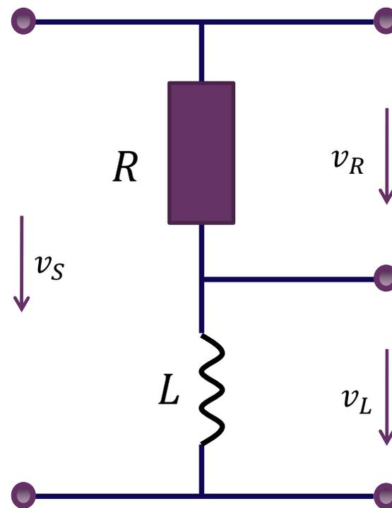
**串联RL：**电阻分压系数具有低通滤波特性；电感分压系数具有高通滤波特性
