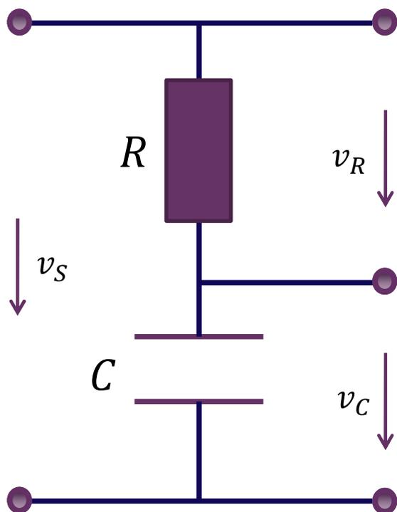
**串联RC：**电容低频开路，分压系数为**1**，电容高频短路，分压系数为**0**；说明电容分压为输入信号中的低频分量，电容分压系数具有低通滤波特性；电阻分压系数在高频为**1**，低频为**0**，说明电阻分压为输入信号中的高频分量，电阻分压系数具有高通滤波器特性
