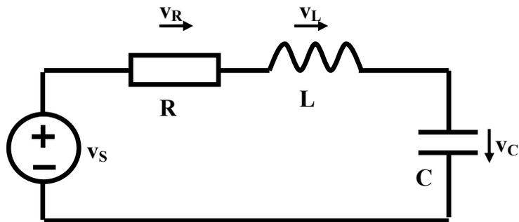
用电路中的任意电量，均可得到形态完全一致的二阶微分电路方程，仅仅是激励的形态不同而已
