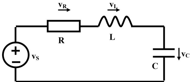
$$\frac{d}{dt} \begin{bmatrix} v_C \\ i_L \end{bmatrix} = \begin{bmatrix} 0 & \frac{1}{C} \\ -\frac{1}{L} & -\frac{R}{L} \end{bmatrix} \begin{bmatrix} v_C \\ i_L \end{bmatrix} + \begin{bmatrix} 0 \\ \frac{1}{L} v_s \end{bmatrix}$$
