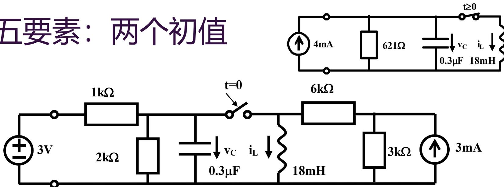
$$v_C(0^-) = \frac{2k\Omega}{1k\Omega + 2k\Omega} \times 3V = 2V$$
