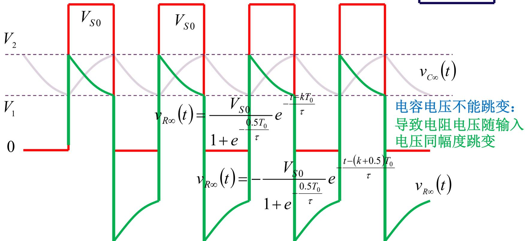
电容电压是输入电压中的低频分量，电容电压平均值为  $0.5V_{S0}$ ，取的是直流附近的分量
