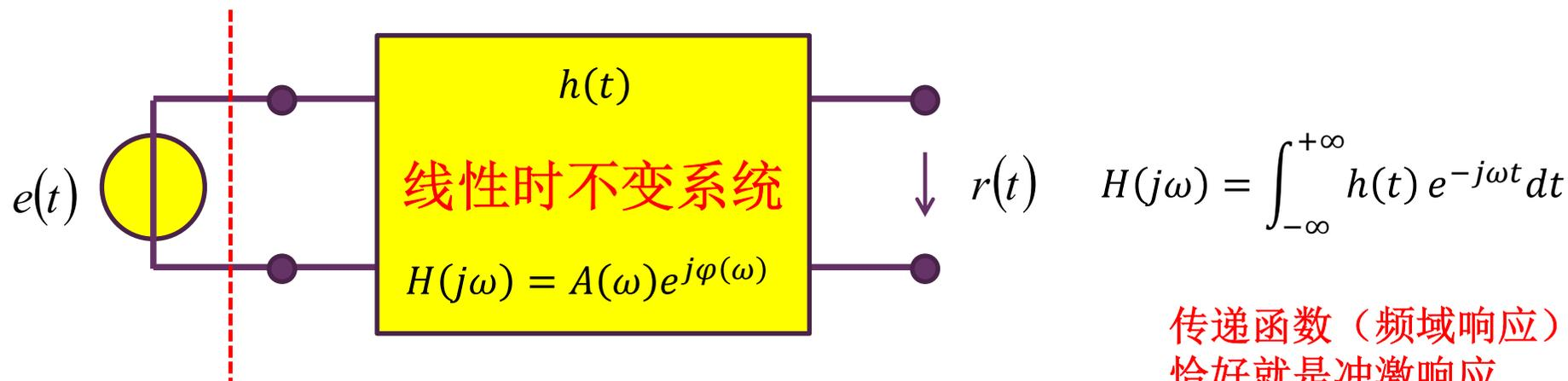
传递函数（频域响应）恰好就是冲激响应（时域响应）的傅立叶变换，传递函数和冲激响应是一对傅里叶变换对，两者对 **LTI** 系统的描述是不同视角的等同描述
