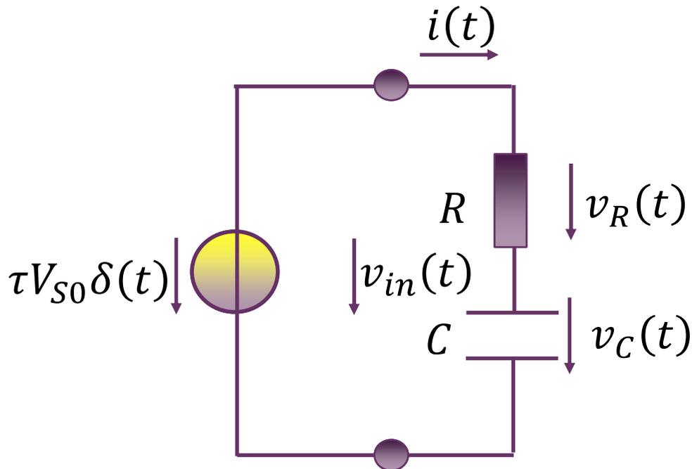
冲激电压 $\tau V_{S0} \delta(t)$ 在 $t = 0$ 瞬间的突变属高频分量，电容高频短路（电容电压不能突变，保持0电压），因此激励电压在 $t = 0$ 瞬间全部加载到电阻上，电阻上产生电流
