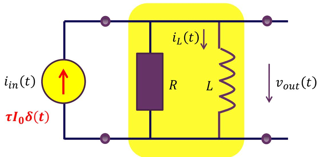
要素3：稳态响应：电感以初始电流 $I_0$ 通过电阻 $R$ 放磁，等待足够长时间，电感储存的磁通（磁能）全部被电阻消耗，故而
