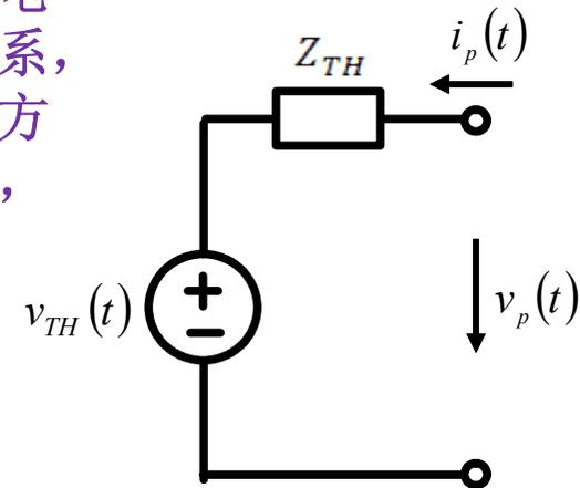
根据叠加定理  $v_p(t) = \alpha i_p(t) + \beta_1 s_1(t) + \beta_2 s_2(t) + \dots = Z_{TH} i_p(t) + v_{TH}(t)$
