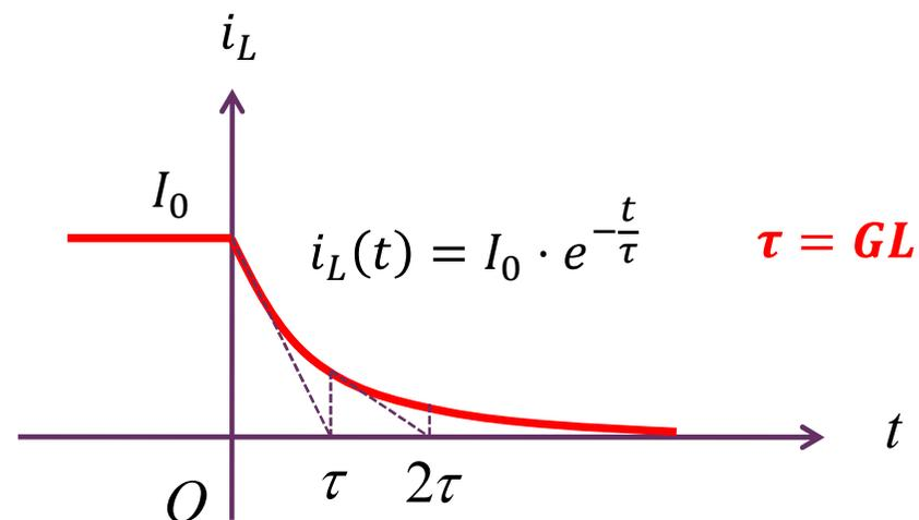
开关断开瞬间，电感电流全部加载到电阻上，形成放磁电压 $-I_0R$ ，该电压对电感放磁，短时分电感电流线性下降，导致加载到电阻上的电流随之下降，放磁电压降低，放磁速率（斜率）下降，最终呈现出指数衰减规律：当电感电流下降为零时，放磁电压为零，电感不再放磁
