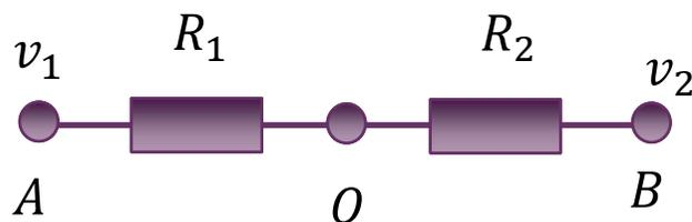
已知结点**A**的电压为 $v_1$ ，结点**B**的电压为 $v_2$ ，求结点**O**的电压，由电压表达式说明该电路可能具有什么功能？
