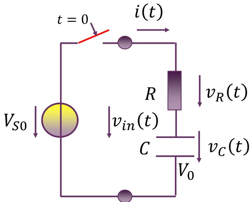
由于是线性电路，根据叠加定理，总响应等于分响应之和，因此全响应等于零状态响应和零输入响应之和
