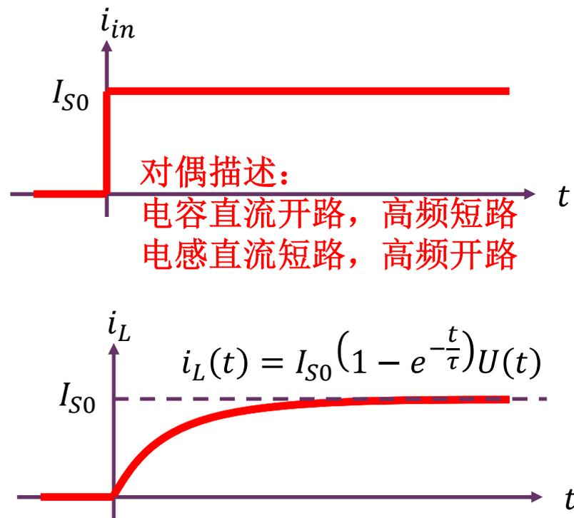
电感电流不能突变，电感电流瞬间为**0**，电感瞬间阻抗为无穷（电感高频开路），结点初始电压为 **$I_{S0}R$** ，该电压对电感充磁，短时分电感电流线性上升，导致电阻分流变小，结点电压下降，充磁电压下降，充磁速率（斜率）下降，电感电流最终呈现出指数衰减的上升规律：当电感电流等于输入电流时，电阻分流为**0**，电阻电压即结点电压为零，不再对电感充磁，电感电流稳定在输入电流上： **$5\tau$** 时间后，阶跃信号可理解为看不到跳变了，只看到直流，电感直流短路，全部直流电电流加载/分流到电感上
