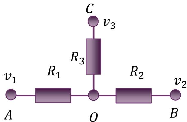
更进一步，假设结点**A**的电压为 $v_1$ ，结点**B**的电压为 $v_2$ ，结点**C**的电压为 $v_3$ ，由结点**O**的电压表达式说明该电路可能具有什么功能？
