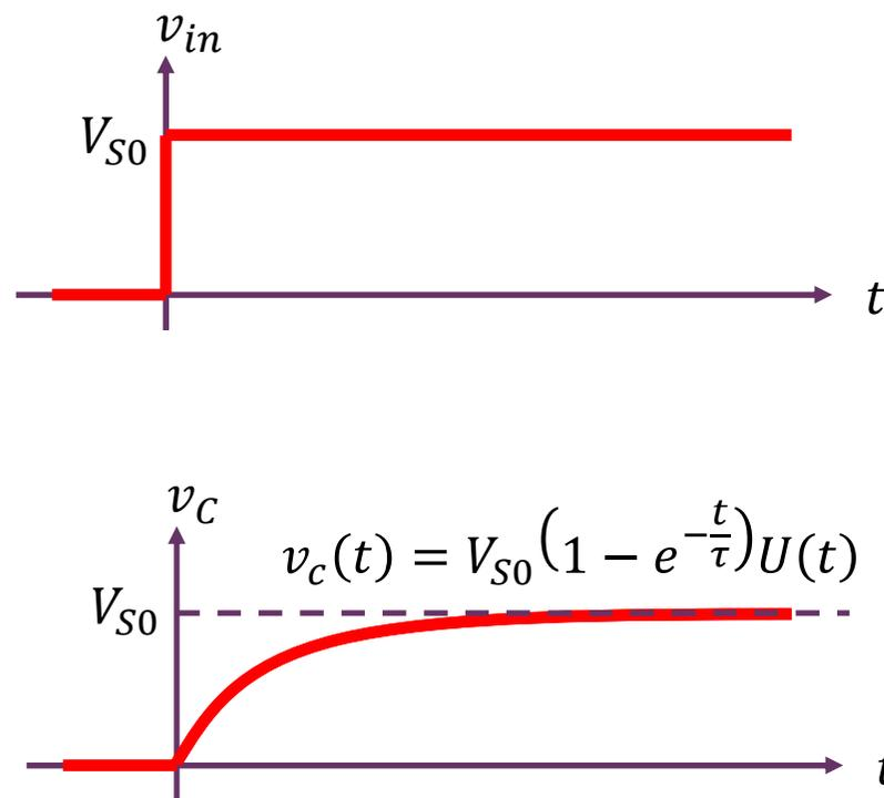
电容电压不能突变，电容电压瞬间为**0**，电容瞬间阻抗为零（电容高频短路），回路初始电流为 **$V_{S0}/R$** ，该电流对电容充电，短时分电容电压线性上升，导致回路电流降低，充电电流减小，充电速率（斜率）下降，电容电压最终呈现出指数衰减的上升规律：当电容电压等于输入电压时，回路电流为零，不再对电容充电，电容电压稳定在输入电压上： **$5\tau$** 时间后，阶跃信号可理解为看不到跳变了，只看到直流，电容直流开路，全部直流电压加载/分压到电容上
