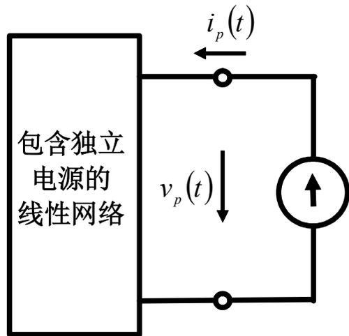
加测试电流，看端口电压，分析电压电流关系，该关系就是端口描述方程，由端口描述方程，给等效电路
