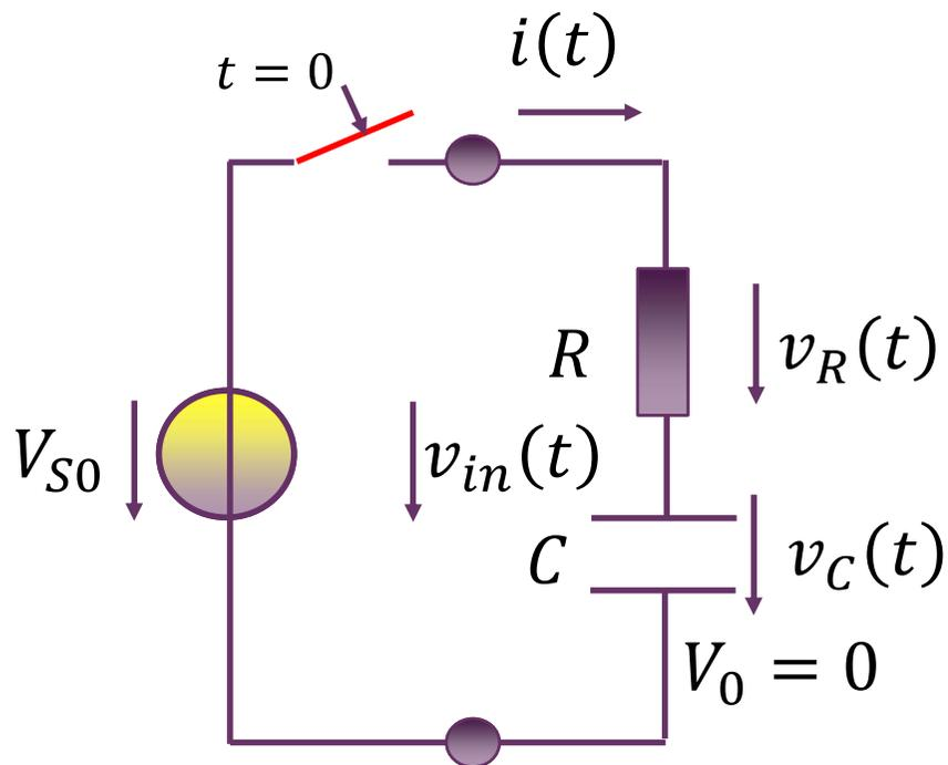
$V_0 = 0$ ，电容初始状态为0时的分析，称此时的响应为零状态响应
