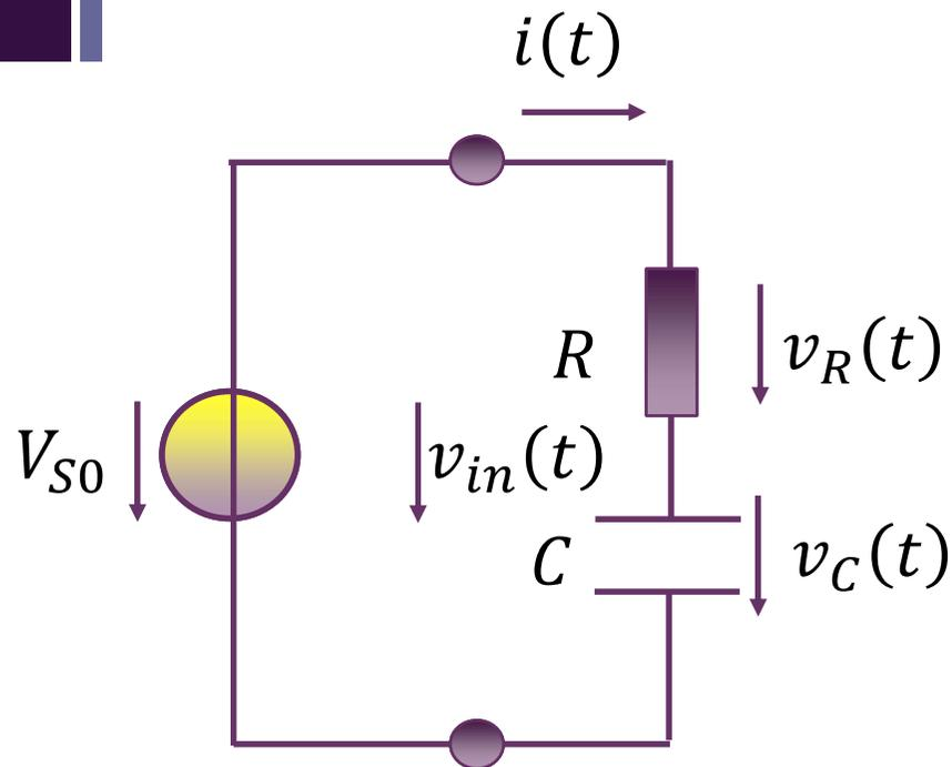
由于**RC**是线性时不变元件，不会产生新的频率分量，因此当直流激励时，电路中就只有有一个直流（零频）分量。直流信号可理解为是在 $t = -\infty$ 时加载的，经过无穷长时间后，电容初始电压（另一个源，叠加定理）的作用已经消失（指数衰减为**0**了），因而直流分析不考虑初值问题
