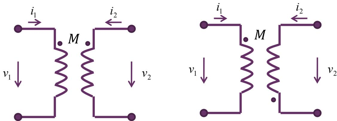
$$\begin{bmatrix} v_1 \\ v_2 \end{bmatrix} = \begin{bmatrix} L_1 & M \\ M & L_2 \end{bmatrix} \frac{d}{dt} \begin{bmatrix} i_1 \\ i_2 \end{bmatrix}$$
