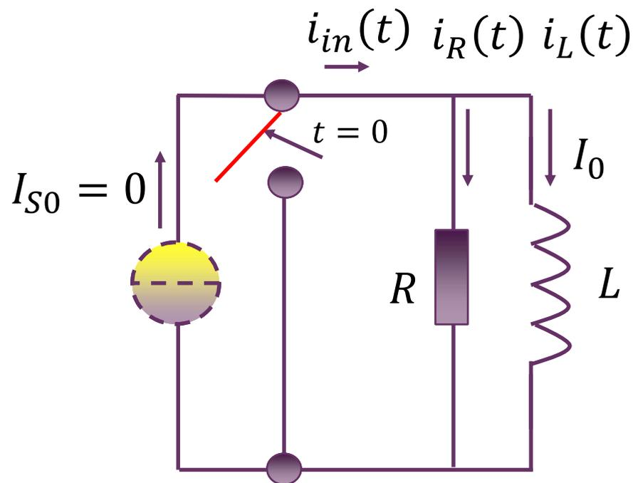
$$i_L(t) = \frac{1}{L} \int_{-\infty}^t v_L(t) dt = I_0 + \frac{1}{L} \int_0^t v_L(t) dt$$
