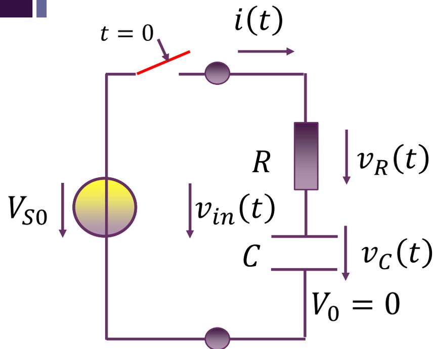
由于是线性电路，根据叠加定理，电阻分压和电容分压由两个源共同决定，第一个源为外加激励源  $v_s(t) = V_{S0}$ ，第二个源为电容初始电压  $V_0$  的等效源，为了简单起见，首先假设  $V_0 = 0$ ，只考虑外加激励源单独作用的分压关系
