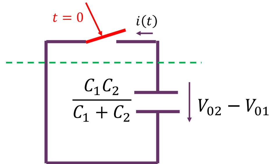
从虚线端口（开关对接端口）看，是一个具有  $V_0 = V_{02} - V_{01}$  初始电压容值为  $C = \frac{C_1 C_2}{C_1 + C_2}$  的电容被开关短路，显然该等效电路将在开关闭合瞬间释放  $CV_0 = \frac{C_1 C_2}{C_1 + C_2} (V_{02} - V_{01})$  的电荷，因而产生  $i(t) = \frac{C_1 C_2}{C_1 + C_2} (V_{02} - V_{01}) \delta(t)$  的冲激电流，以电磁辐射形式将等效电容的储能  $\frac{1}{2} CV_0^2 = \frac{1}{2} \frac{C_1 C_2}{C_1 + C_2} (V_{02} - V_{01})^2$  全部释放出去
