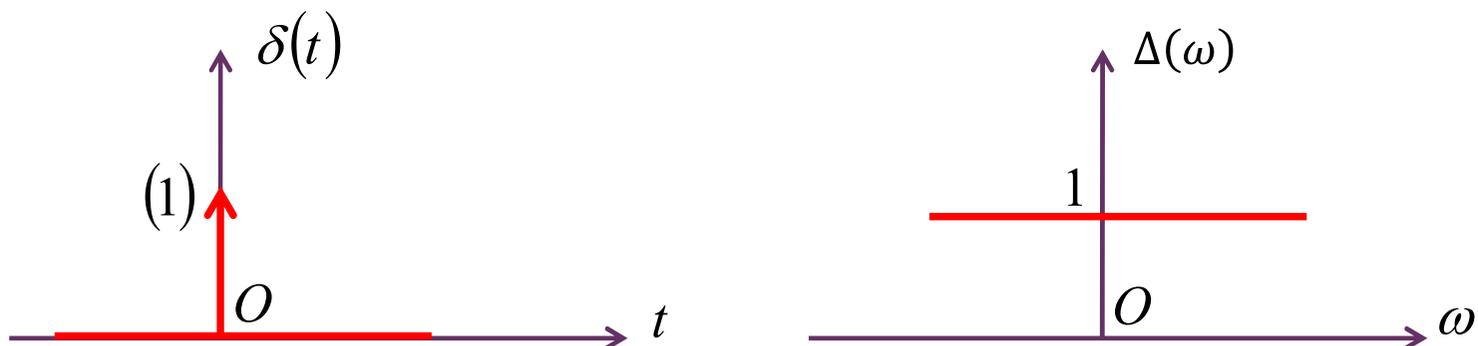
只有满足准静态条件  $d_{AB} \ll \lambda$ ，电磁场问题方可抽象为电路问题。对于冲激信号，其频谱覆盖全频带且所有频率分量幅值相同，因而电路中不可能存在这种信号。当数学上抽象出冲激信号时，在电路中则表现为电磁辐射，原因是此时电路尺寸大于或可比拟高频信号的波长，此时电路已经无法将电磁波束缚在电路导体、介质周围空间，电路变成开放结构（天线），以电磁辐射形式将能量释放到周围空间。
