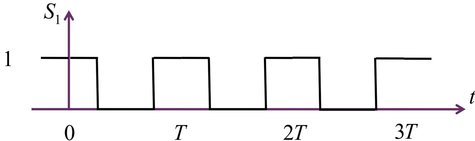
$$S_1(t) = \begin{cases} 1 & t \in \left[ kT - \frac{T}{4}, kT + \frac{T}{4} \right] \\ 0 & t \in \left[ kT + \frac{T}{4}, kT + \frac{3T}{4} \right] \end{cases} \quad k = 0, \pm 1, \pm 2, \dots$$
