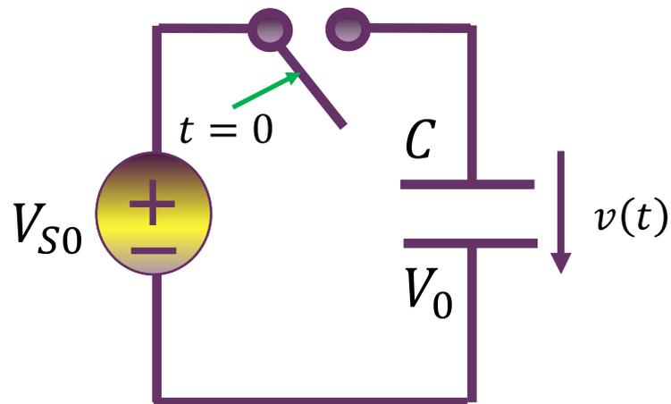
电压源 $t=0$ 瞬间以恒压 $V_{S0}$ 向外提供 $C(V_{S0} - V_0)$ 的电荷量，电源对外做功
