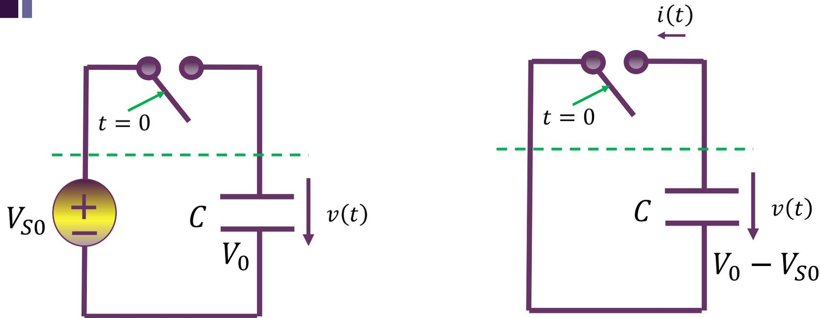
从虚线端口（开关对接端口）看，是一个具有  $V_0 - V_{S0}$  初始电压容值为  $C$  的电容被开关短路，显然该等效电路将在开关闭合瞬间释放  $C(V_0 - V_{S0})$  的电荷，因而产生  $i(t) = C(V_0 - V_{S0})\delta(t)$  的冲激电流，以电磁辐射形式将等效电容的储能  $\frac{1}{2}C(V_{S0} - V_0)^2$  全部释放出去
