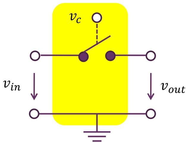
$$v_{out} = \begin{cases} v_{in} & v_c > 0 \text{ 开关闭合} \\ 0 & v_c < 0 \text{ 开关断开} \end{cases} = S_w(v_c) \cdot v_{in}$$
