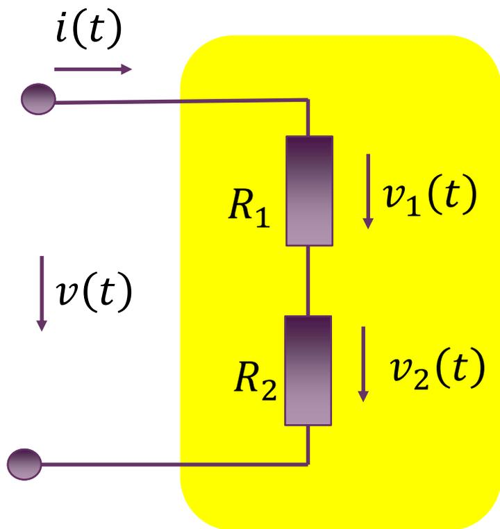
$$v(t) = v_1(t) + v_2(t) \quad \text{KVL方程}$$
