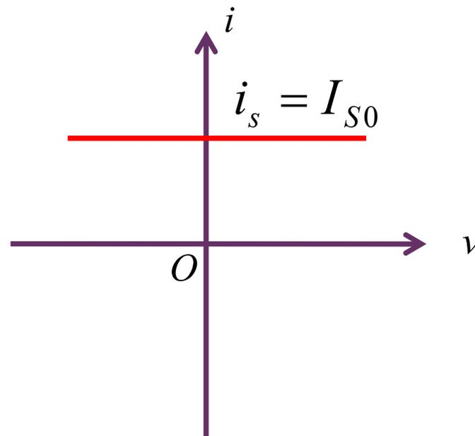
注意：电源的电压电流关联参考方向和电阻不一致
