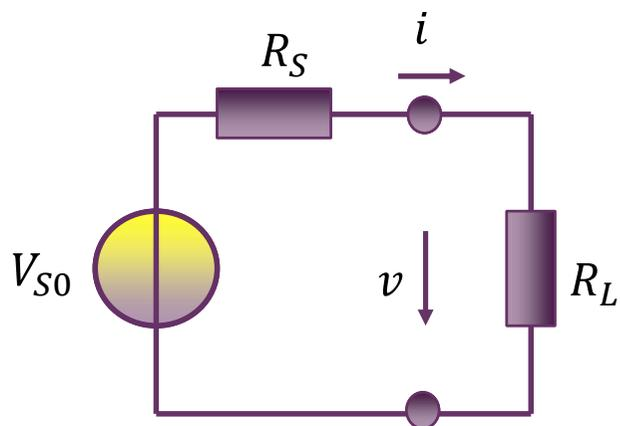
按源关联参考和阻关联参考方向定义端口电压电流，使得对接端口共用一套端口电压电流定义，从而可以在一个  $\mathbf{vi}$  平面上画出电源和负载的伏安特性曲线，可以用图解法进行电路分析
