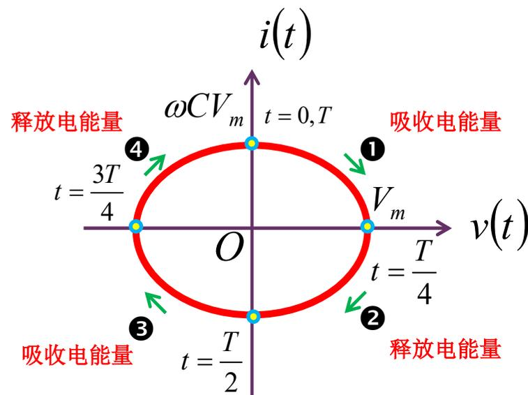
一个正弦周期内：**1/4**周期吸收电能，**1/4**周期释放电能，再吸再放：储能元件/无损元件
