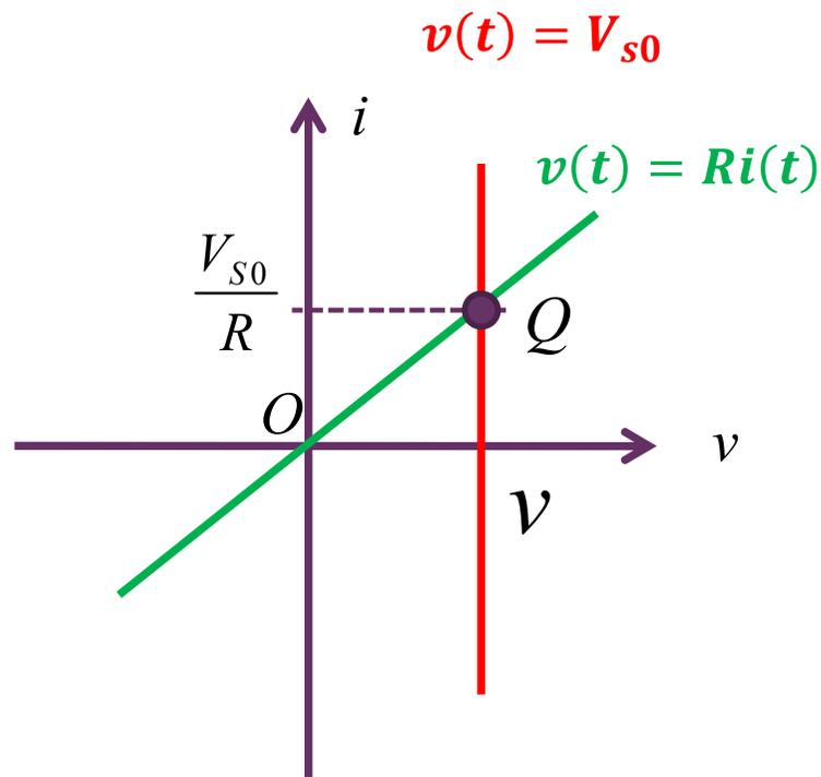
这种关联参考方向定义可以确保两个单端口网络的伏安特性曲线可以画在一个  $\mathbf{vi}$  平面内，伏安特性曲线的交点就是端口电压、端口电流
