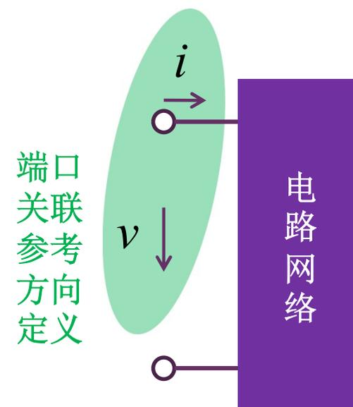
电路系统的功能，体现在端口电压电流关系上
