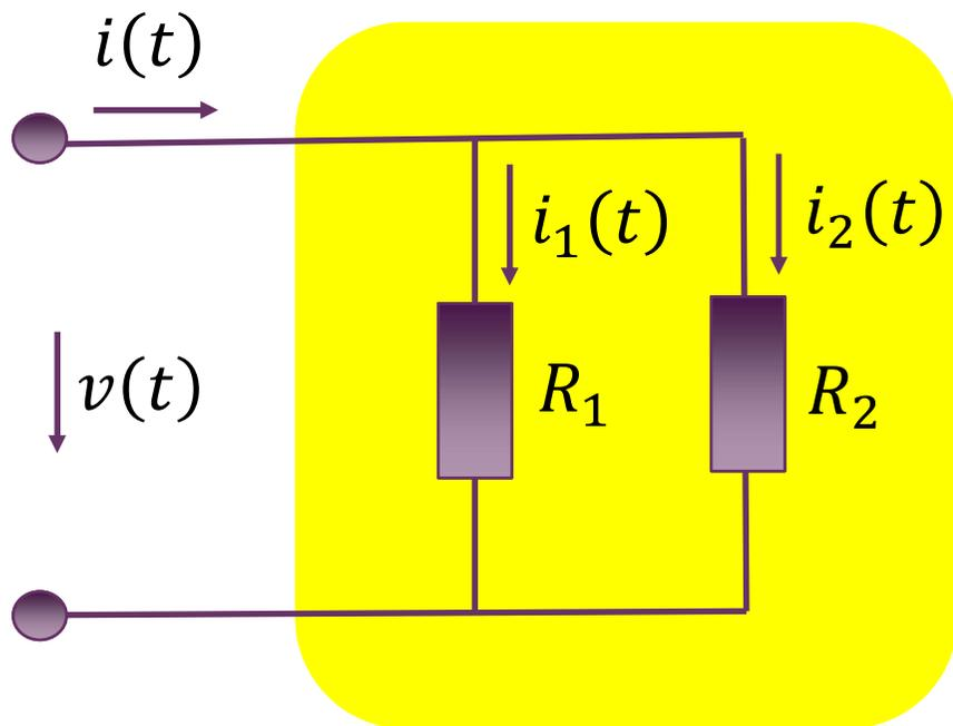
$$i(t) = i_1(t) + i_2(t) \quad \text{KCL方程}$$
