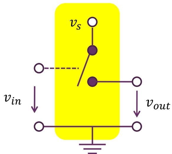
$$v_{out} = \begin{cases} v_s & v_{in} > 0 \text{ 开关闭合} \\ 0 & v_{in} < 0 \text{ 开关断开} \end{cases}$$
