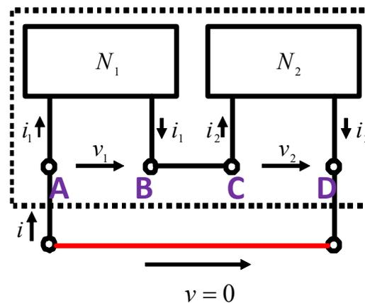
只需定义一套端口电压、端口电流足矣：KVL、KCL自动满足
