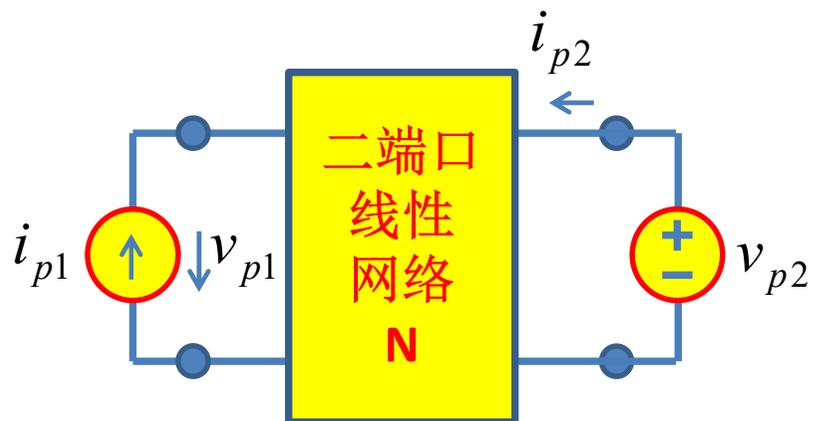
1端口加流、2端口加压测量：混合参量： hybrid parameters
