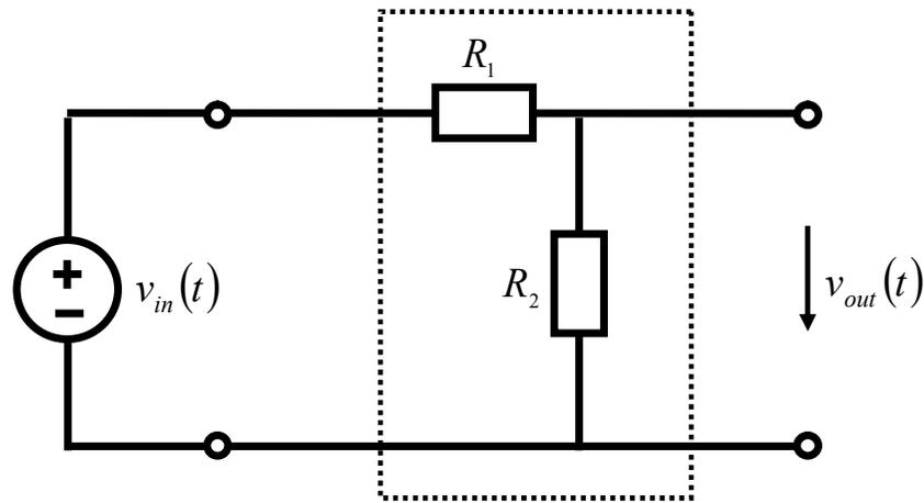
串联总电压等于分电压之和
