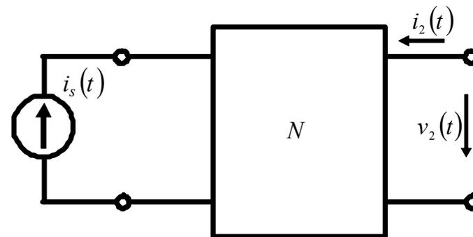
先假设内部独立源都置零：内部独立电压源短路，内部独立电流源开路
