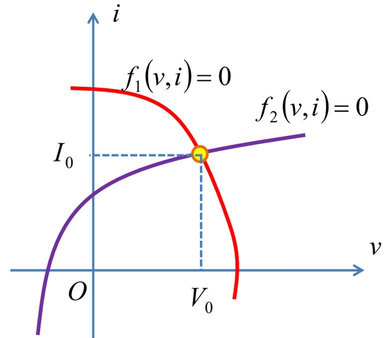
图解法的最大优点是直观，使得非线性电路的解可直观获得
