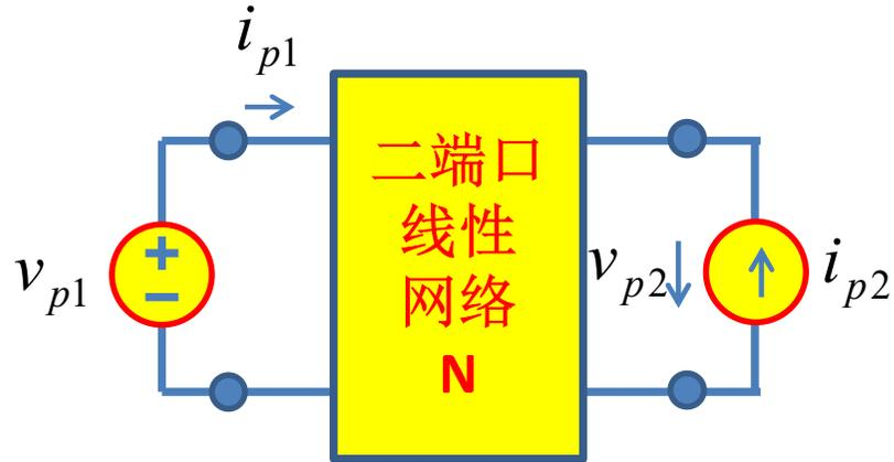
1端口加压、2端口加流测量：逆混参量：inverse hybrid parameters
