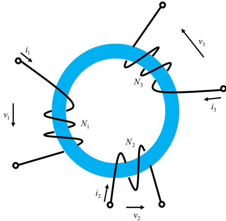
(a) 三端口电感绕制方式
