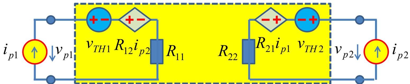
$$\begin{bmatrix} v_1 \\ v_2 \end{bmatrix} = \begin{bmatrix} R_{11} & R_{12} \\ R_{21} & R_{22} \end{bmatrix} \begin{bmatrix} i_1 \\ i_2 \end{bmatrix} + \begin{bmatrix} v_{TH1} \\ v_{TH2} \end{bmatrix}$$
