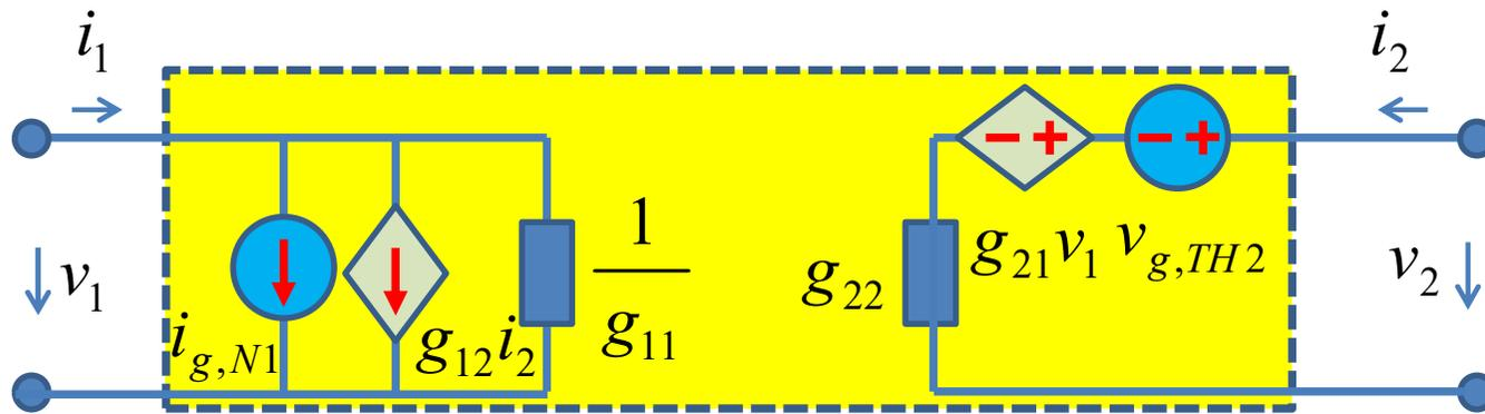
$$\begin{bmatrix} i_1 \\ v_2 \end{bmatrix} = \begin{bmatrix} g_{11} & g_{12} \\ g_{21} & g_{22} \end{bmatrix} \begin{bmatrix} v_1 \\ i_2 \end{bmatrix} + \begin{bmatrix} i_{g,N1} \\ v_{g,TH2} \end{bmatrix}$$
