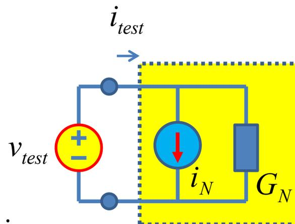
$$i_{test} = G_N \cdot v_{test} + i_N$$
