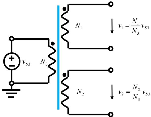
(b) 三端口理想变压器信号分解
