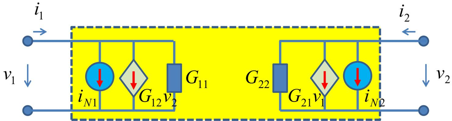
$$\begin{bmatrix} i_1 \\ i_2 \end{bmatrix} = \begin{bmatrix} G_{11} & G_{12} \\ G_{21} & G_{22} \end{bmatrix} \begin{bmatrix} v_1 \\ v_2 \end{bmatrix} + \begin{bmatrix} i_{N1} \\ i_{N2} \end{bmatrix}$$
