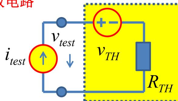
$$v_{test} = R_{TH} \cdot i_{test} + v_{TH}$$
