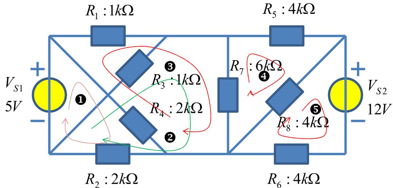
$$\begin{bmatrix} R_4 + R_2 & R_2 & -R_4 & 0 & 0 \\ R_2 & R_3 + R_7 + R_2 & R_7 & -R_7 & 0 \\ -R_4 & R_7 & R_4 + R_1 + R_7 & -R_7 & 0 \\ 0 & -R_7 & -R_7 & R_7 + R_5 + R_8 & -R_8 \\ 0 & 0 & 0 & -R_8 & R_8 + R_6 \end{bmatrix} \begin{bmatrix} i_{l1} \\ i_{l2} \\ i_{l3} \\ i_{l4} \\ i_{l5} \end{bmatrix} = \begin{bmatrix} +V_{S1} \\ 0 \\ 0 \\ 0 \\ -V_{S2} \end{bmatrix}$$
