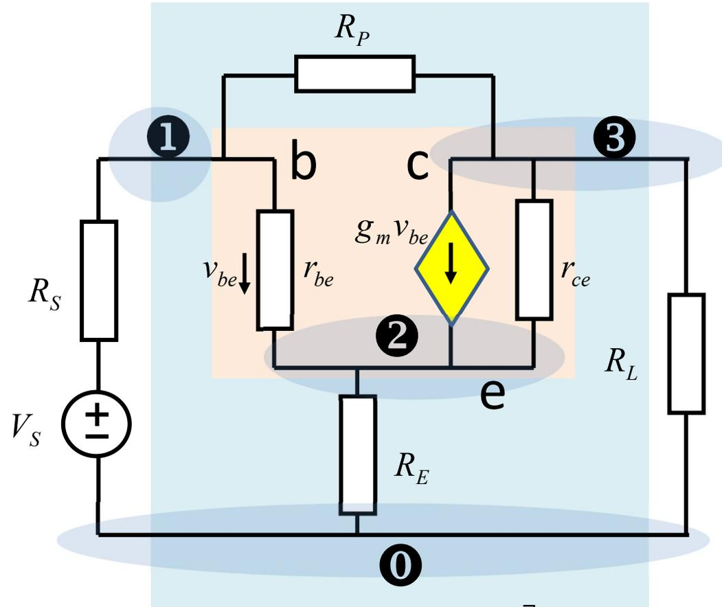
$$\begin{bmatrix} G_S + g_{be} + G_p & -g_{be} & -G_p \\ -g_{be} & g_{be} + g_{ce} + G_E & -g_{ce} \\ -G_p & -g_{ce} & g_{ce} + G_p + G_L \end{bmatrix} \begin{bmatrix} v_b \\ v_e \\ v_c \end{bmatrix} = \begin{bmatrix} V_S G_S \\ g_m v_{be} \\ -g_m v_{be} \end{bmatrix} = \begin{bmatrix} V_S G_S \\ g_m (v_b - v_e) \\ g_m (v_e - v_b) \end{bmatrix}$$
