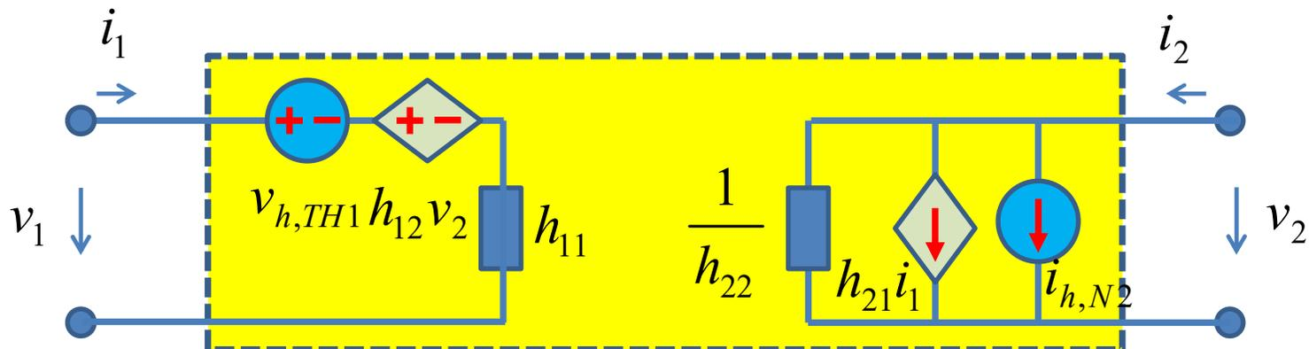
$$\begin{bmatrix} v_1 \\ i_2 \end{bmatrix} = \begin{bmatrix} h_{11} & h_{12} \\ h_{21} & h_{22} \end{bmatrix} \begin{bmatrix} i_1 \\ v_2 \end{bmatrix} + \begin{bmatrix} v_{h,TH1} \\ i_{h,N2} \end{bmatrix}$$
