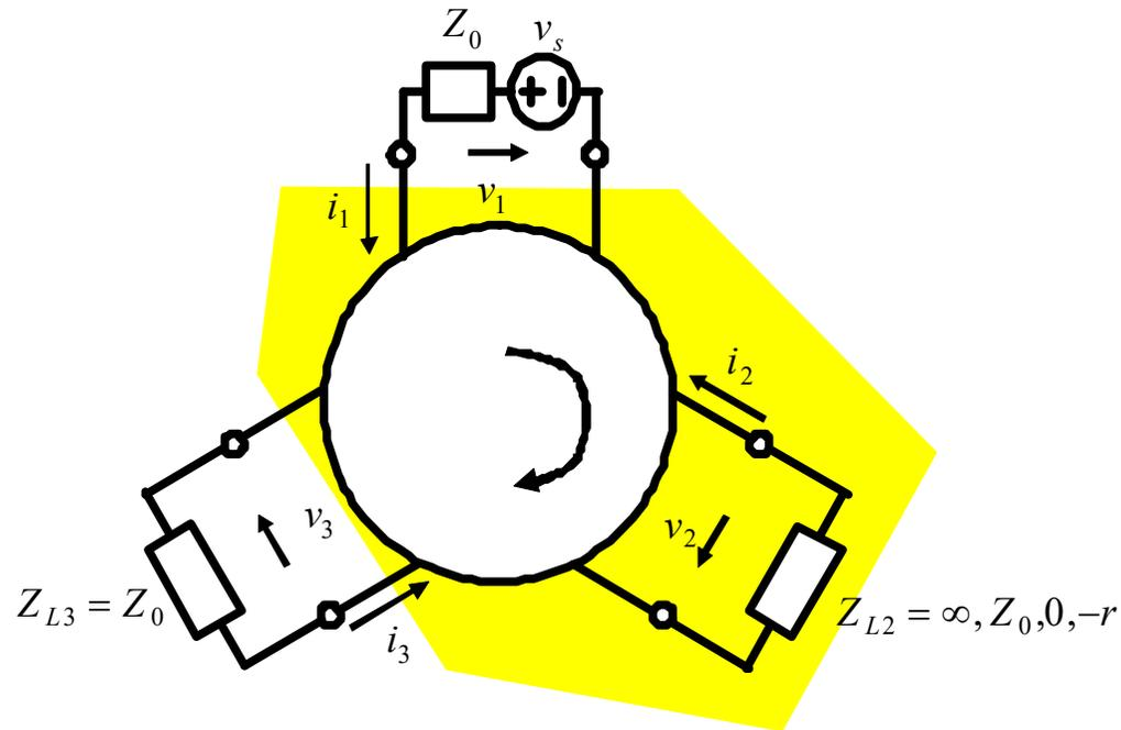
证明：（1）当端口2开路或短路时，环行器端口1吸收的功率全部从端口3送出，为端口3匹配负载吸收
