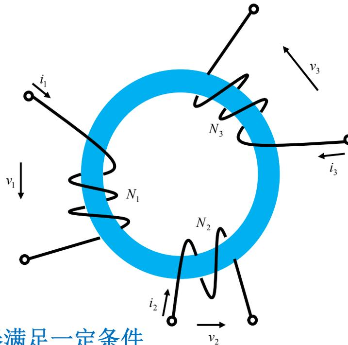
(a) 三端口电感绕制方式
