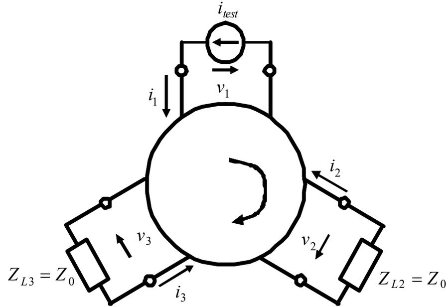
$$\begin{bmatrix} v_1 \\ v_2 \\ v_3 \\ i_1 \\ i_2 \\ i_3 \end{bmatrix} = \begin{bmatrix} Z_0 \\ -Z_0 \\ 0 \\ 1 \\ 1 \\ 0 \end{bmatrix} i_{test}$$
