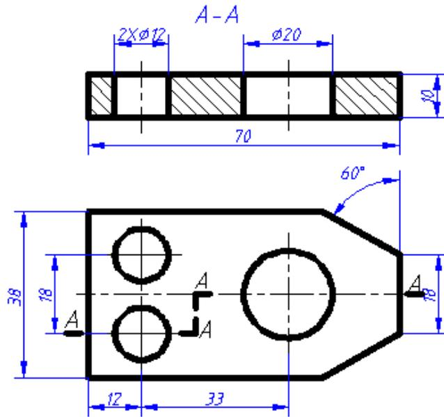
4-2-1-4 圈出不符合基本规则的尺寸注法，并在下面图中完成正确的尺寸标注。
