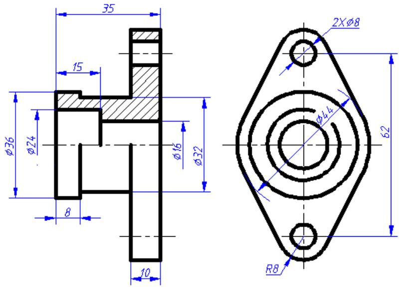
4-2-1-5 圈出不符合基本规则的尺寸注法，并在下面图中完成正确的尺寸标注。
