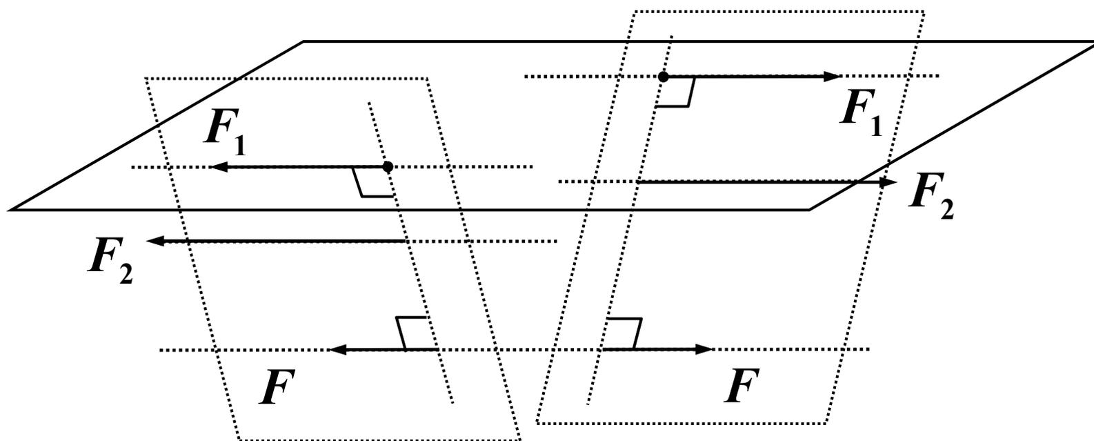
两个  $F_1$  是真实力偶。任选两个在同一作用线上的等值反向力  $F$ ，和  $F_1$  平行，但不在原力偶平面。求合力，变成由两个合力  $F_2$  构成的平行于原力偶平面的新力偶，和原力偶等价。
