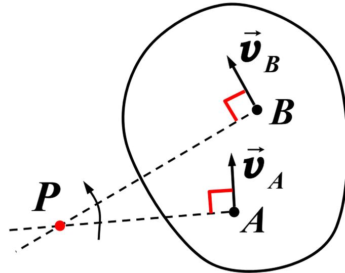
$$\left\{ \begin{array}{l} |\vec{R}| = \overline{PA} = v_A / \omega \\ \vec{R} \text{ 方向沿 } \vec{v}_A \times \vec{\omega} \text{ 的方向} \end{array} \right.$$
