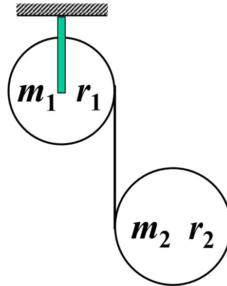
解：设绳中张力  $T$ ， $m_1$  角加速度  $\alpha_1$ ， $m_2$  质心加速度  $a_C$ ，角加速度  $\alpha_2$ ，绳上  $A$  点加速度  $a$ 。
