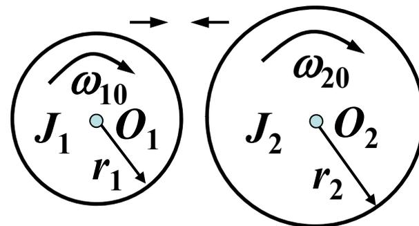
对每个轮作隔离分析，用角动量定理求解。
