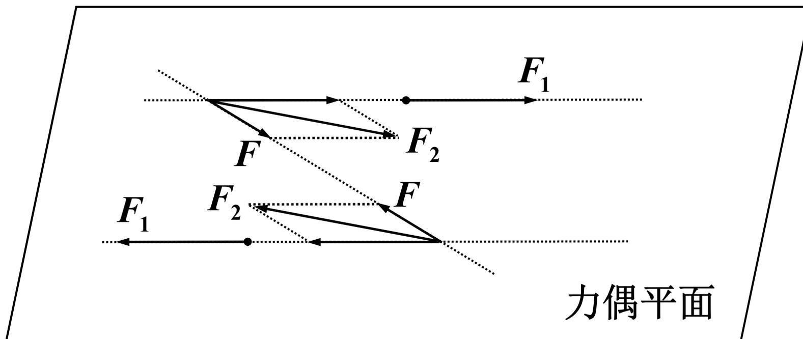
两个  $F_1$  是真实力偶。在力偶平面上任选两个在同一作用线上的等值反向力  $F$ ，求合力，变成由两个合力  $F_2$  构成的在同平面的新力偶，和原力偶等价。
