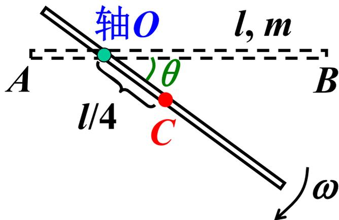
求：杆下摆到  $\theta$  角时的角速度  $\omega$  和轴对杆的作用力  $\vec{N}$ 。
