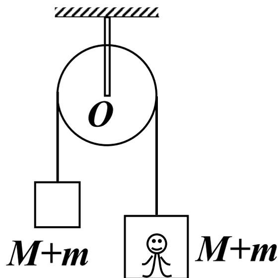
**解：**对升降亭+滑轮+人+平衡重物系统，外力对滑轮中心  $O$  点力矩为零，角动量守恒。
