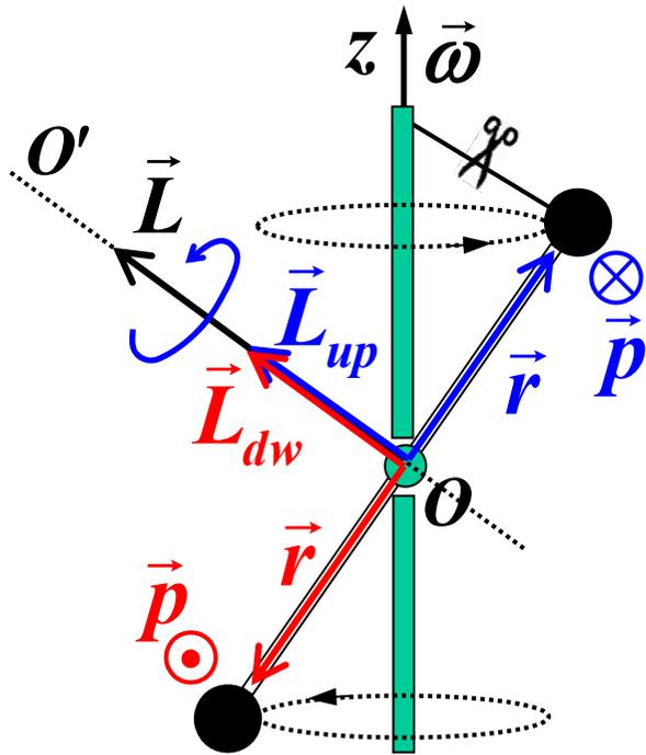
剪断瞬间及之后时间，对  $O$  点角动量守恒，能“眼见”保持沿剪断瞬间的  $OO'$  轴作定轴转动。实际按欧拉陀螺的动力学分析，角动量守恒没错，但对转动的分析不是这么简单。
