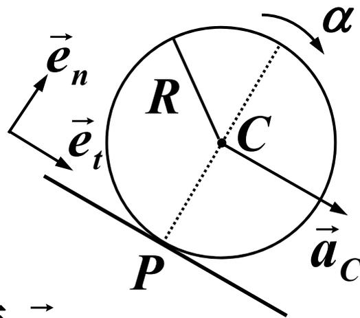
**证明：**  $P$  点相对水平面的加速度  $\vec{a}_P$  沿  $PC$  连线方向。
