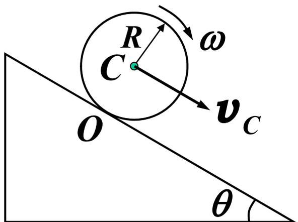
**【例】** 在固定斜面上的圆柱体从静止开始作纯滚动，圆柱体质量  $m$ ，半径  $R$ ，转动惯量  $J$ ，斜面倾角  $\theta$ 。
