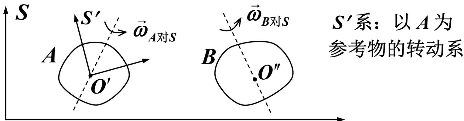
设刚体  $A$ 、 $B$  在静止系  $S$  中分别以角速度  $\vec{\omega}_{A对S}$ 、 $\vec{\omega}_{B对S}$  绕定点  $O'$ 、 $O''$  作定点转动，则物体  $B$  相对物体  $A$  或相对转动系  $S'$  的角速度为：
