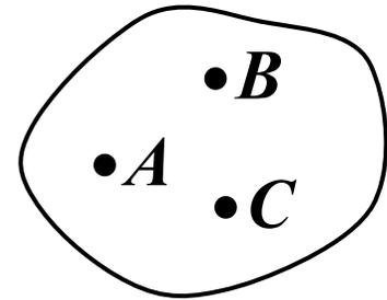
3 个点总坐标数是 9，但  $\overline{AB}$ ,  $\overline{BC}$ ,  $\overline{CA}$  距离不变，这 3 个条件使独立坐标数减少 3 个。
