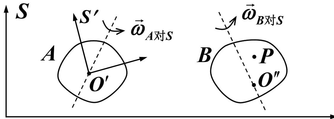
$$\Rightarrow (\vec{\omega}_{A对S} - \vec{\omega}_{B对S} + \vec{\omega}_{B对S'}) \times \vec{r}_{P对O''} = \mathbf{0}$$
