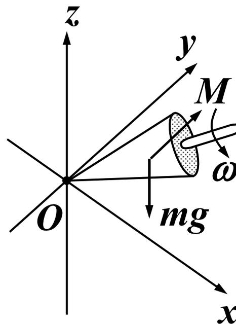
回转仪对于力矩的反应 — 高速自转时自转轴朝力矩方向偏转是普遍的，称为**回转效应**。
