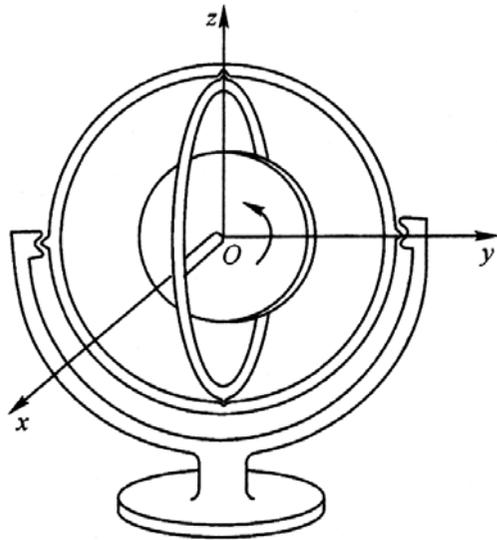
常平架的内外圈转动能抵消外力矩，使得陀螺不受力矩作用，这从陀螺参考系很容易理解。这样陀螺能保持转动方向不变——空间定向
