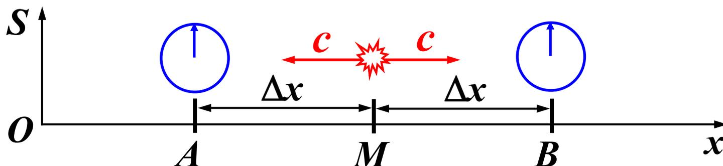
中点  $M$  发出的光信号同时到达  $A$ 、 $B$ ，到达时刻将静止在  $A$ 、 $B$  两地的钟拨到同一时刻，即对准。
