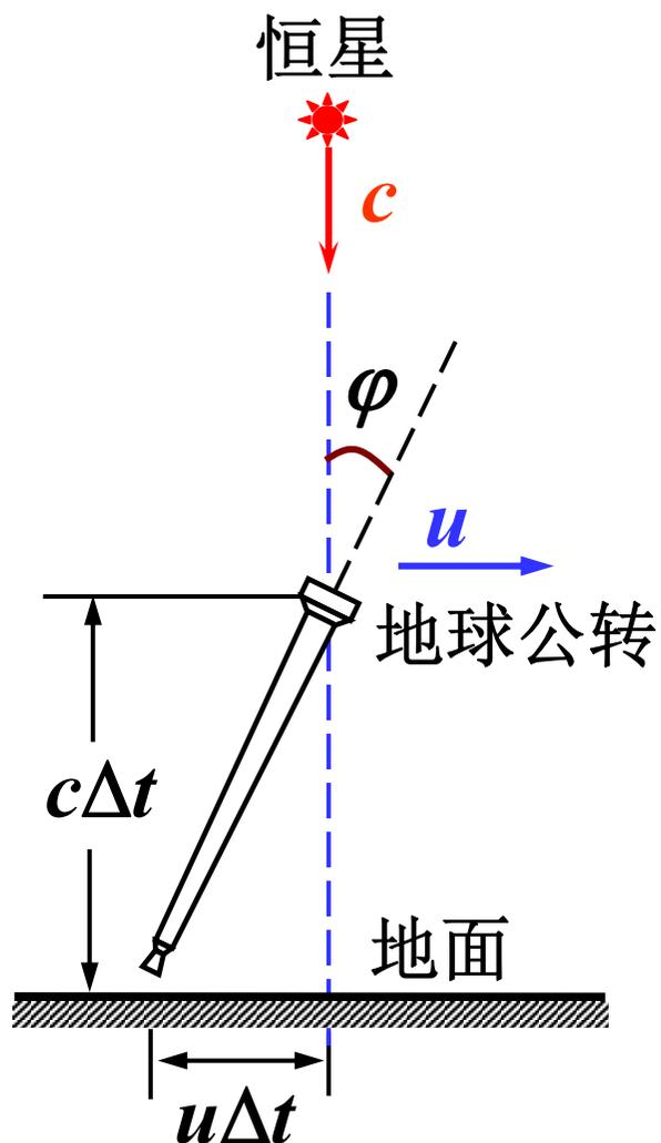
观测地球正上方的恒星时，望远镜须向地球公转方向倾斜一个小角度  $\varphi$ ：
