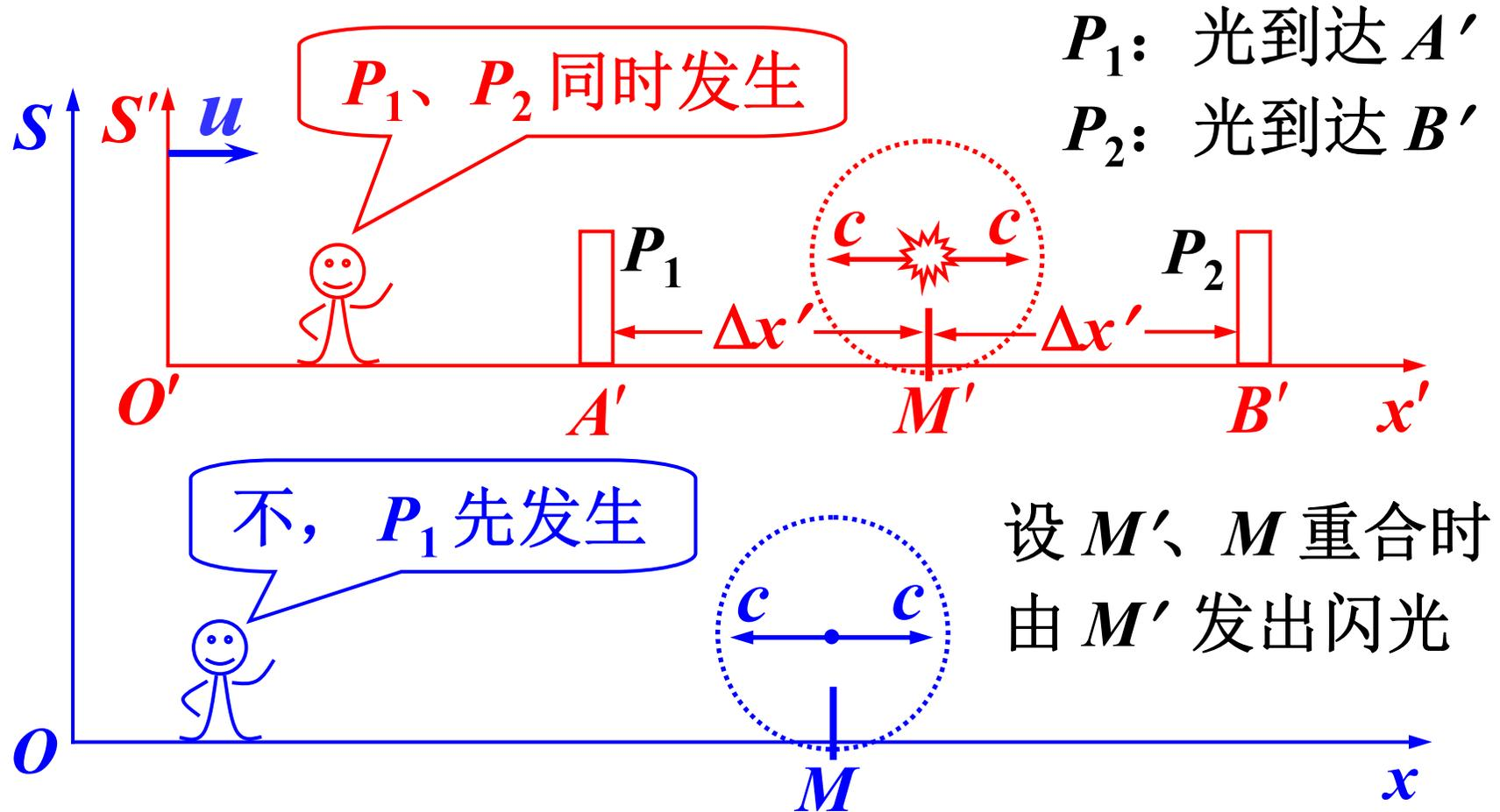
沿两个惯性系相对运动方向配置的两个事件，若在一个惯性系中这两个事件同时发生，则在另一惯性系中观测，总是处于前一个惯性系运动后方的事件先发生。
