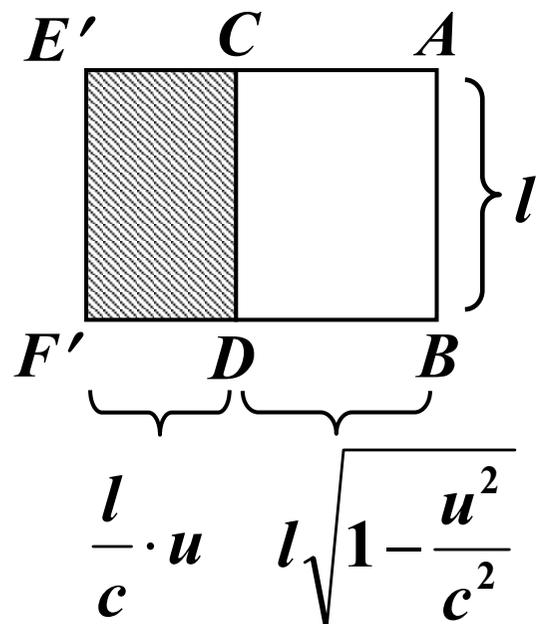
这相当于立方体保持原长静止不动，绕俯视方向的轴旋转一个角度后的观察结果。
