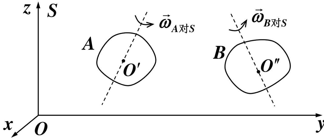
设物体  $A$ 、 $B$  在静止系  $S$  中分别以角速度  $\vec{\omega}_{A对S}$ 、 $\vec{\omega}_{B对S}$  绕定点  $O'$ 、 $O''$  作定点转动，则物体  $B$  相对  $A$  的角速度为：
