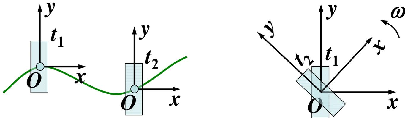
**转动参考系：**参考物只作转动，相固连的坐标框架转动，方位变。
