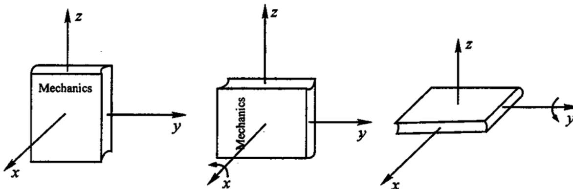
(b) 先绕  $y$  轴转  $90^\circ$ , 再绕  $x$  轴转  $90^\circ$
