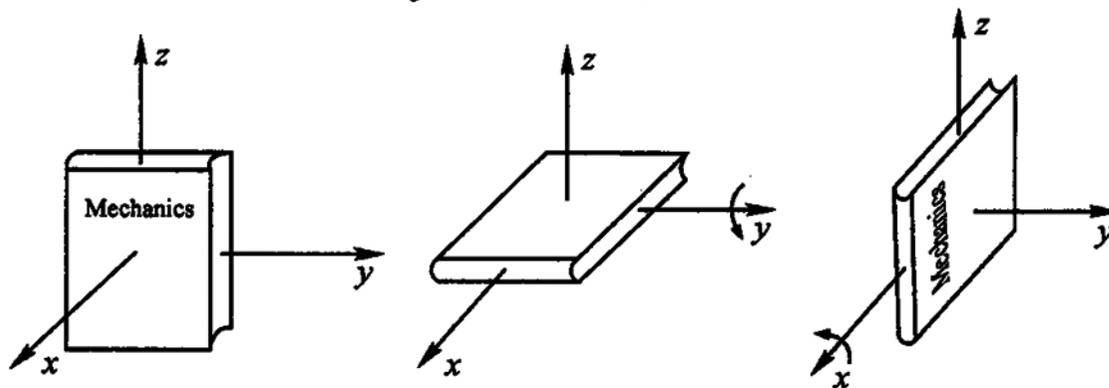
(a)、(b) 结果不同表明：物体绕 2 个相交轴相继转过 2 个有限角度，结果和 2 次转动的次序有关。
