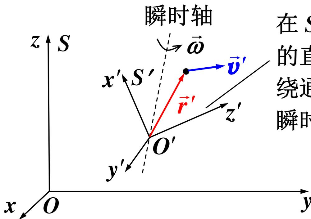
在  $S$  系，代表  $S'$  系的直角坐标框架  $x'y'z'$  绕通过固定点  $O'$  的瞬时轴作定点转动
