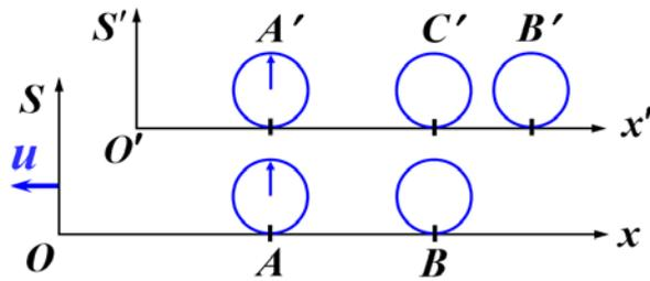
对 P1 和 P3:  $\Delta x' = l'_{AB}$ ,  $\Delta t' = 0$ , 求出  $\Delta t = \gamma \frac{u}{c^2} l'_{AB} = 0.06$ , 所以  $B$  钟的读数为 0.06s。
