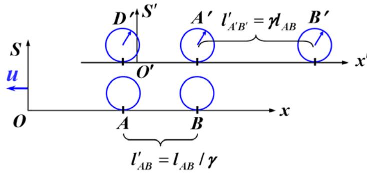
对 P4 和 P5:  $\Delta x' = -l'_{AB}$ ,  $\Delta t' = 0$ , 求出  $\Delta t = \gamma[0 + \frac{u}{c^2}(-l'_{AB})] = -0.06$ , 根据 (3) 问知 P4 发生时 B 的读数是 0.1666s, 所以 A' 与 B 钟相遇时, A 钟的读数为: B 钟读数 +  $\Delta t = 0.10666s$ 。
