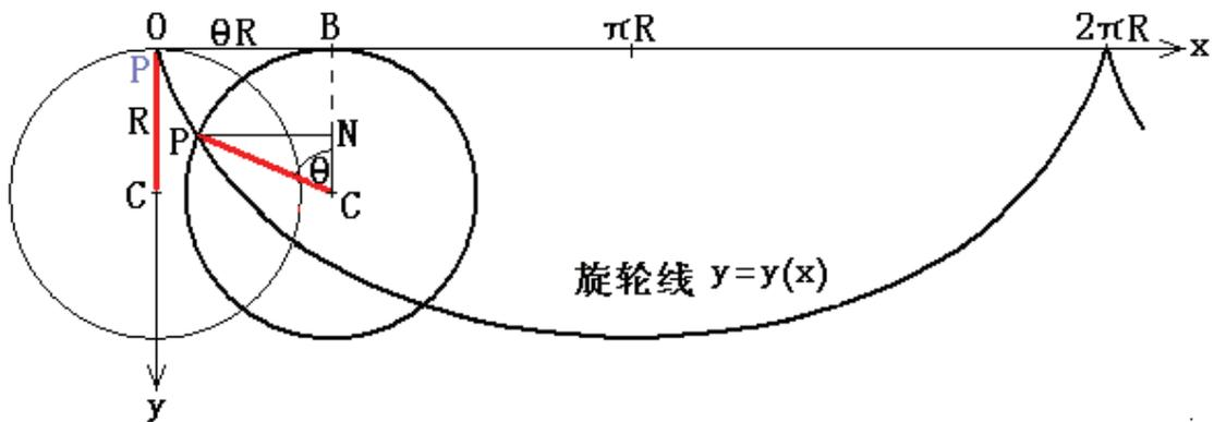
如上图所示，在  $xy$  直角坐标系的  $xy$  平面内有一个圆  $C$  (旋轮)，它沿  $x$  轴作纯滚动，圆周上一点  $P$ ，初始位置与原点重合，在圆  $C$  作纯滚动过程中， $P$  点的轨迹就是旋轮线。设圆  $C$  的半径为  $R$ ，可据上图比较容易地得到  $p$  点轨迹的参数方程。以  $PC$  为画在圆上的记号。设圆  $C$  与  $x$  轴的切点由初始位置  $O$ ，经过圆  $C$  作纯滚动而到达  $B$  点，记号  $PC$  转过角度  $\theta$ ，且  $OB = \theta R$ ，此时  $p$  点的横坐标为线段  $OB$  减去线段  $PN$ ， $p$  点的纵坐标为圆半径减去线段  $NC$ 。由此可知，起始点在原点的旋轮线的参数方程为：
