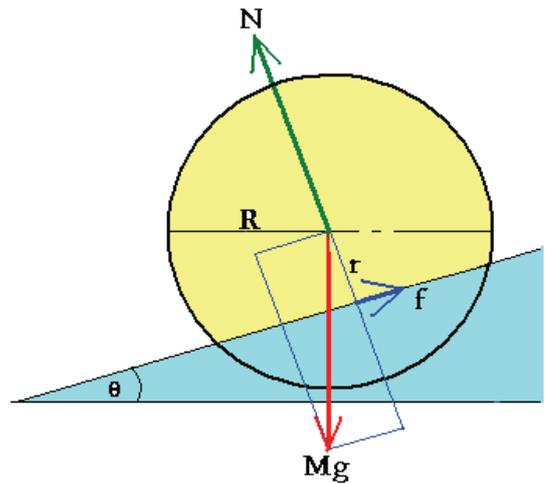
如果球在光滑的轨道上只滑动不滚动，则  $a_c = g \sin \theta$ ，即球的纯滚动与纯滑动的质心加速度仅相差一个与仪器结构有关的因子。对上面三个轨道，结构因子相同。这样球在三个轨道下落快慢的问题，可以等效地用球光滑滑动（质点）替代实际的球纯滚动（刚体）进行讨论，所得结论不变。
